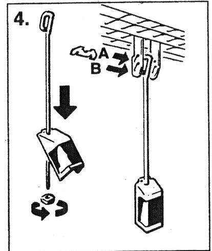
Schlitz A: für Gitterhöhe bis 35 mm
