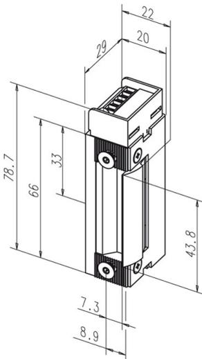
Modell mit Rückmeldekontakt als potentialfreier Wechselkontakt. Dieser wird über einen Schieber von der Schlossfalle betätigt. Justiermöglichkeit des Türöffners im Schließblech und daher eine ideale Arbeitserleichterung bei der Montage.
