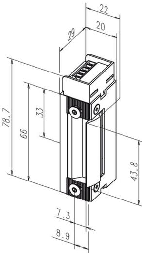
Das Modell bietet Ihnen eine Justiermöglichkeit des Türöffners im Schließblech und daher eine ideale Arbeitserleichterung bei der Montage.
