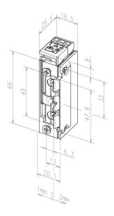
Modell mit Rückmeldekontakt als potentialfreier Wechselkontakt. Dieser wird von der Schlossfalle betätigt.
