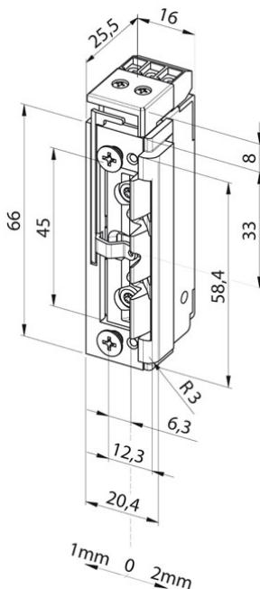
Modell mit bipolarer Schutzdiode. Passend zu den effeff-Schließblechen 78A, 44B, 63B und 82B. Rückmeldekontakt als potentialfreier Wechselkontakt. Dieser wird von der Schlossfalle betätigt. Auch als Sicherheitstüröffner verwendbar.
