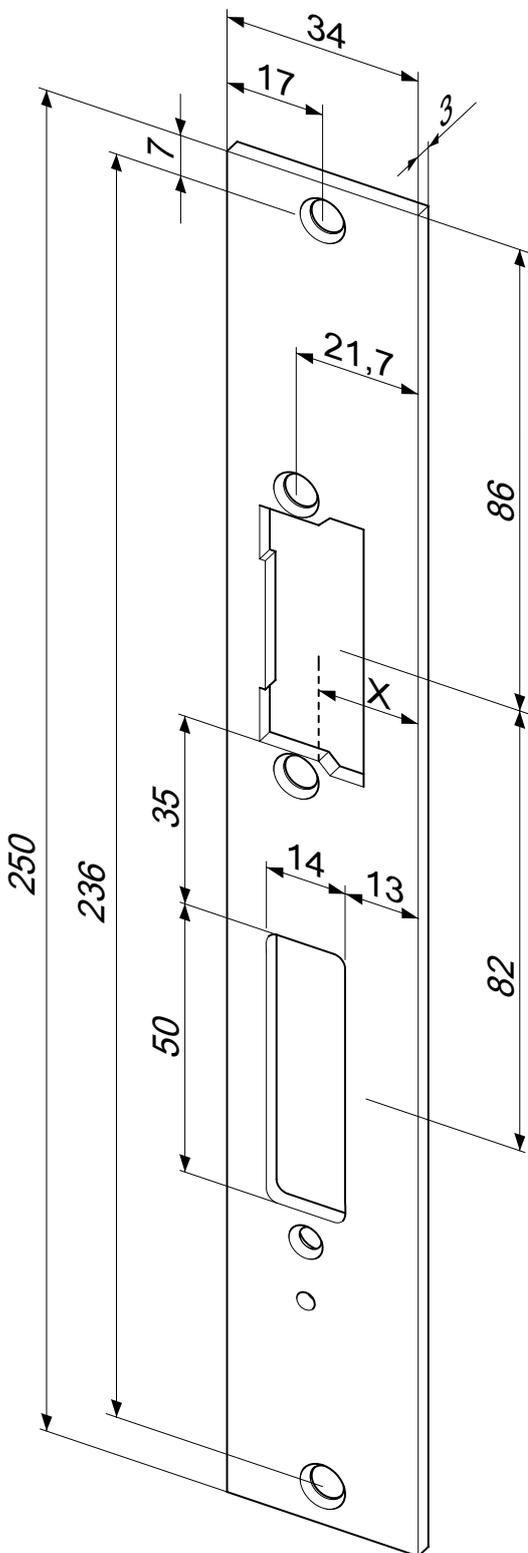
Flachschließblech mit Fallen- und Riegelausschnitt.
