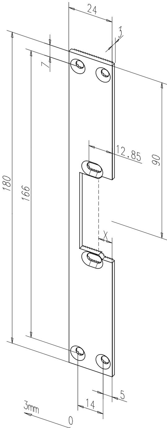
Kurzes Flachschießblech mit Fallenausschnitt.
