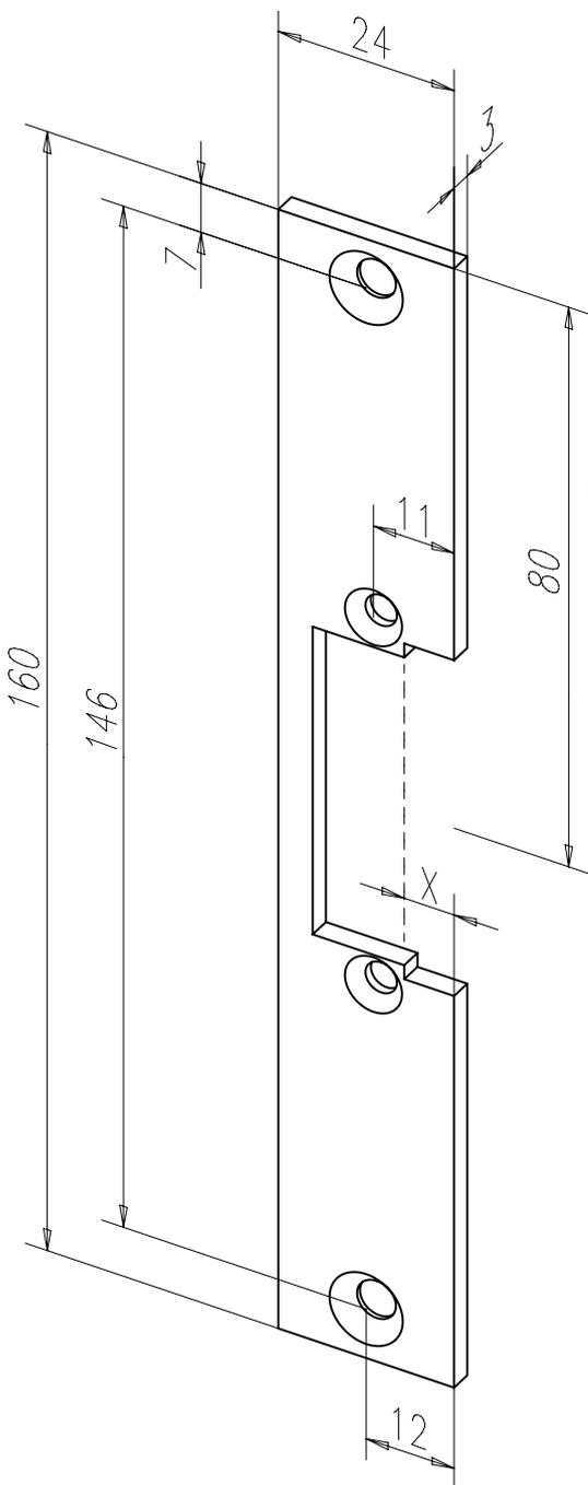
Kurzes Flachschießblech mit Fallenausschnitt.
