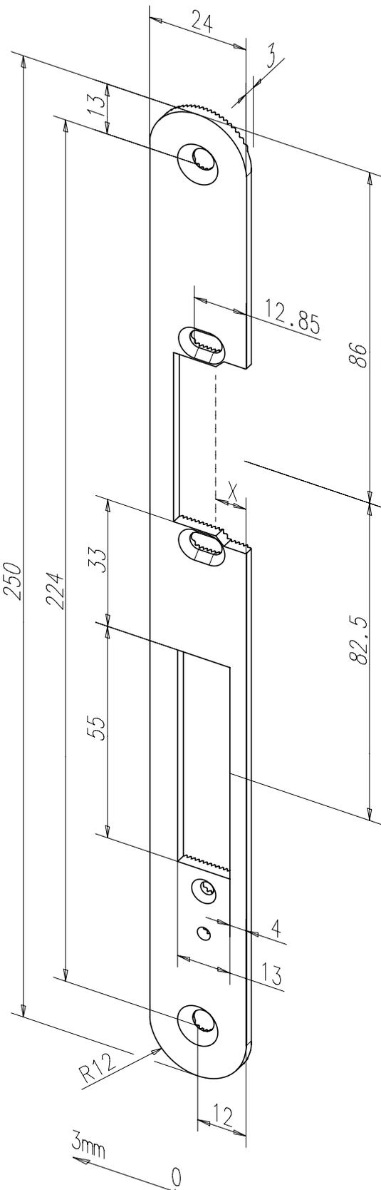
Flachschließblech mit Fallen- und Riegelausschnitt.
