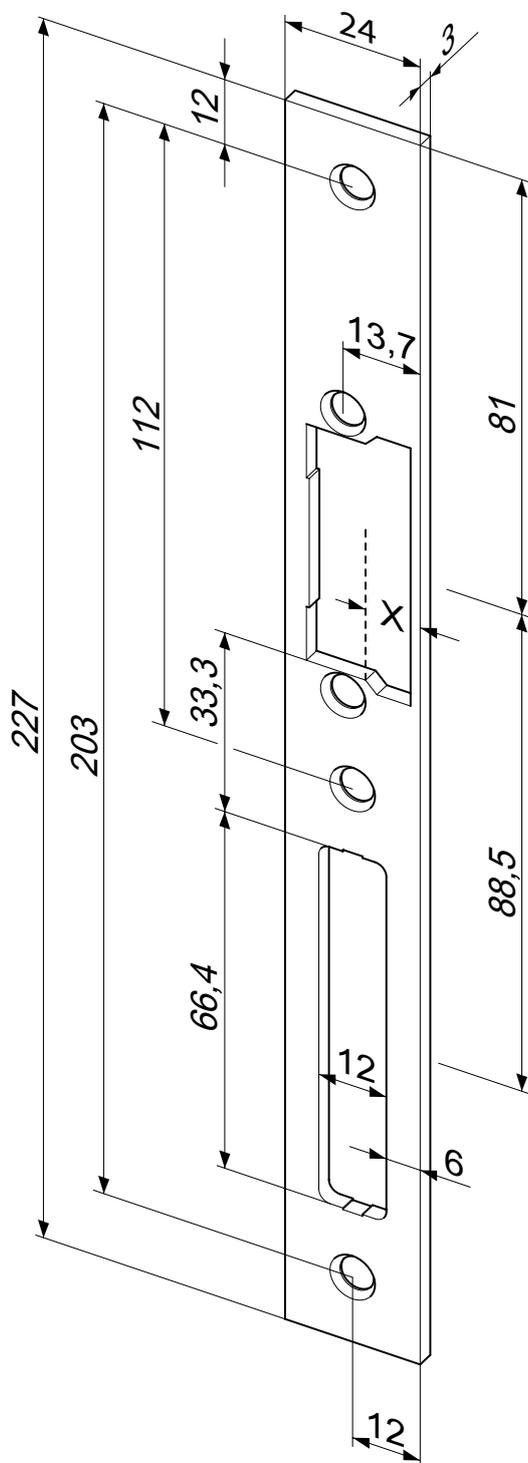
ProFix® 2 Flachschließblech mit Fallen- und Riegelausschnitt.
