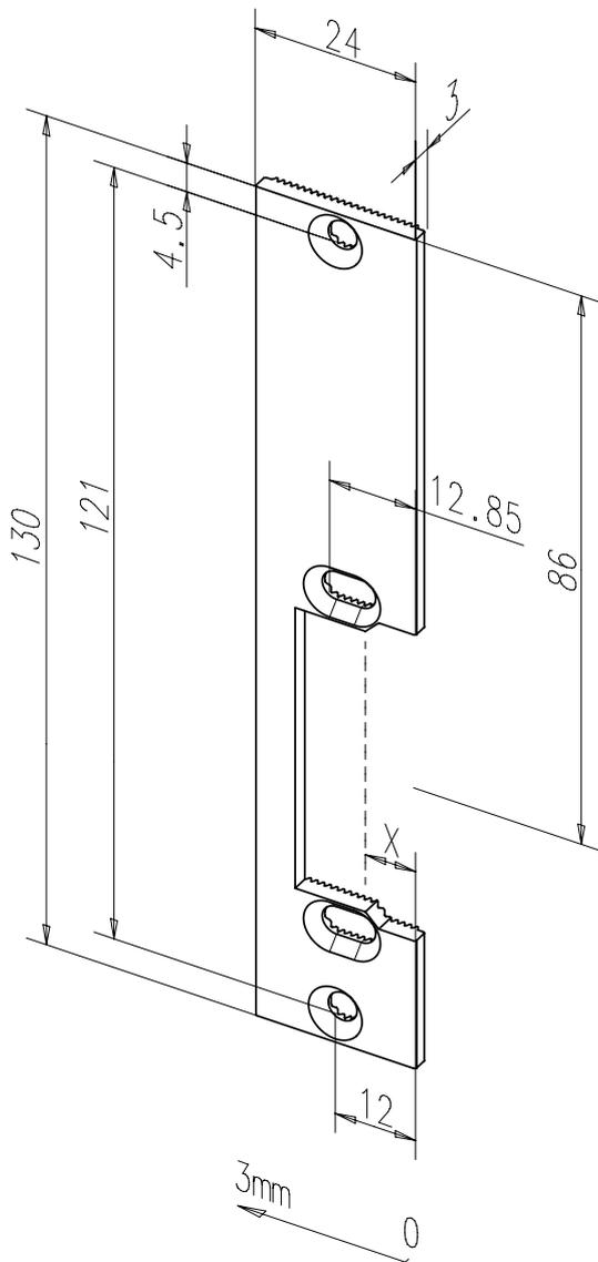
Kurzes Flachschießblech mit Fallenausschnitt.
