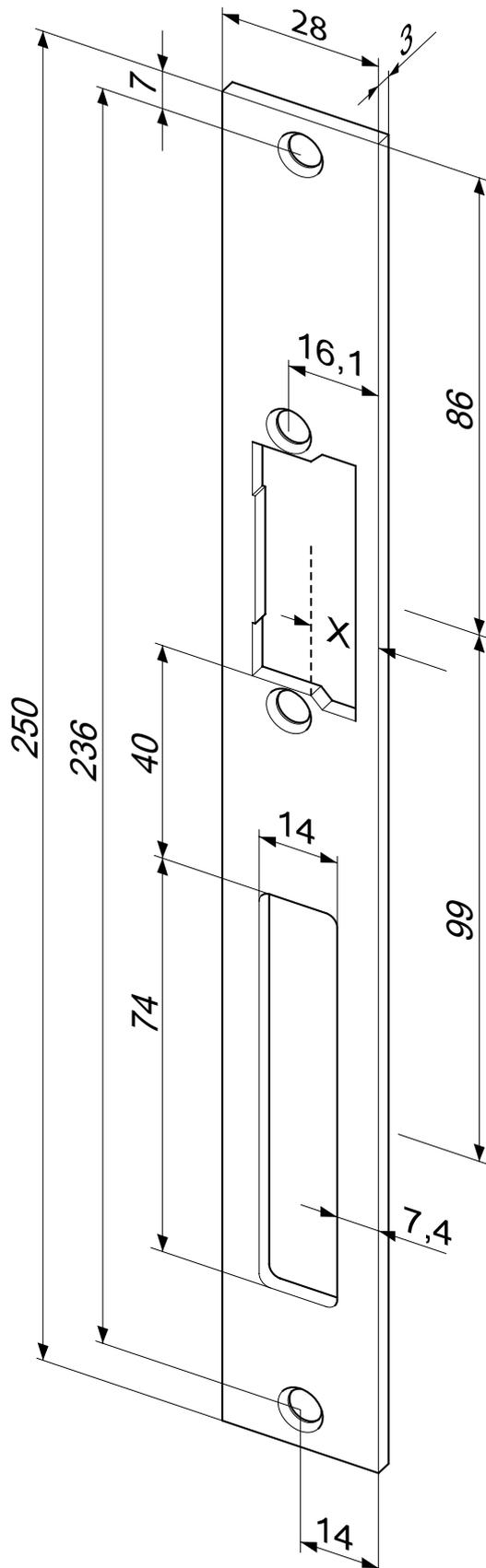
Flachschließblech mit Fallen- und Riegelausschnitt.
