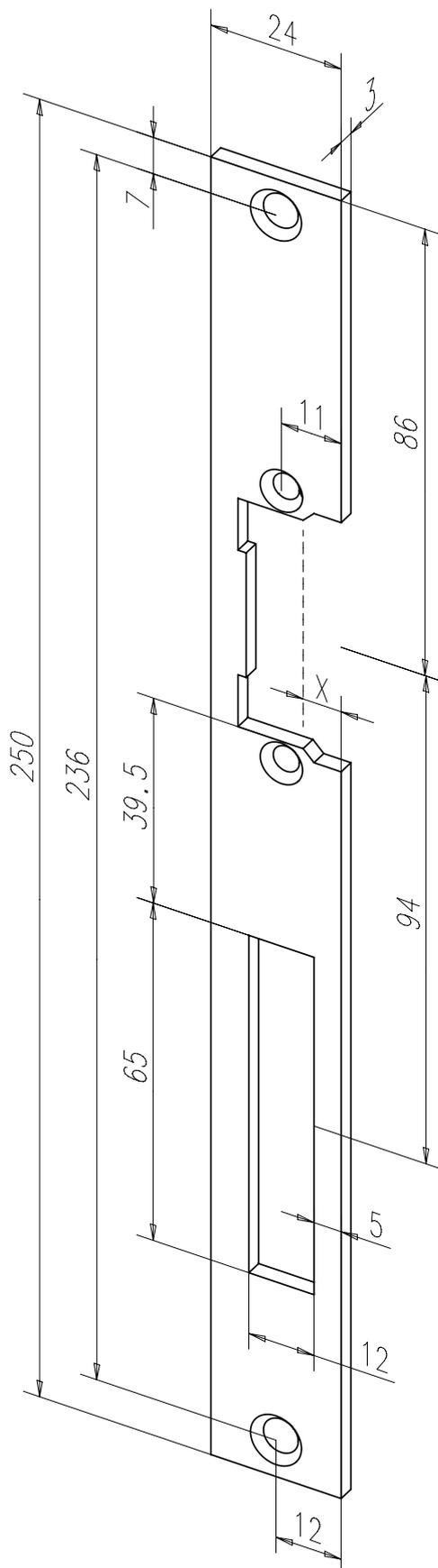
Standard-Flachschließblech mit Fallen- und Riegelausschnitt.
