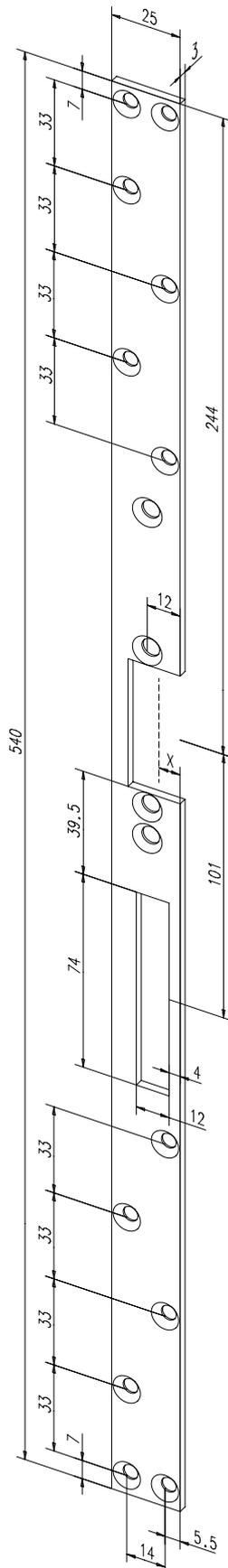
Sicherheits-Flachschließblech mit Fallen- und Riegelausschnitt.
