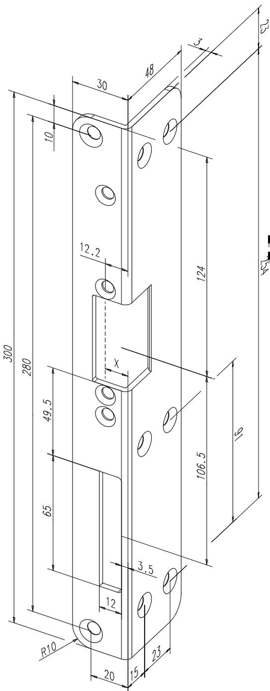
Winkelschließblech mit Fallen- und Riegelausschnitt.
