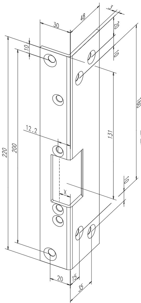
Kurzes Winkelschließblech mit Fallenausschnitt.
