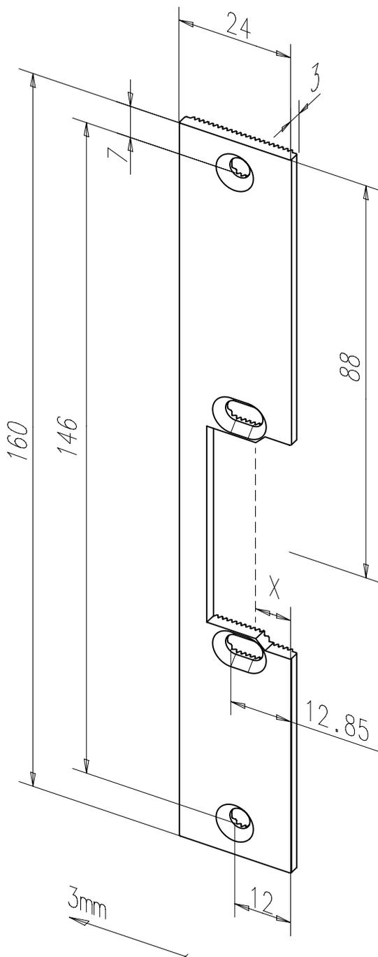
Kurzes Flachschießblech mit Fallenausschnitt.
