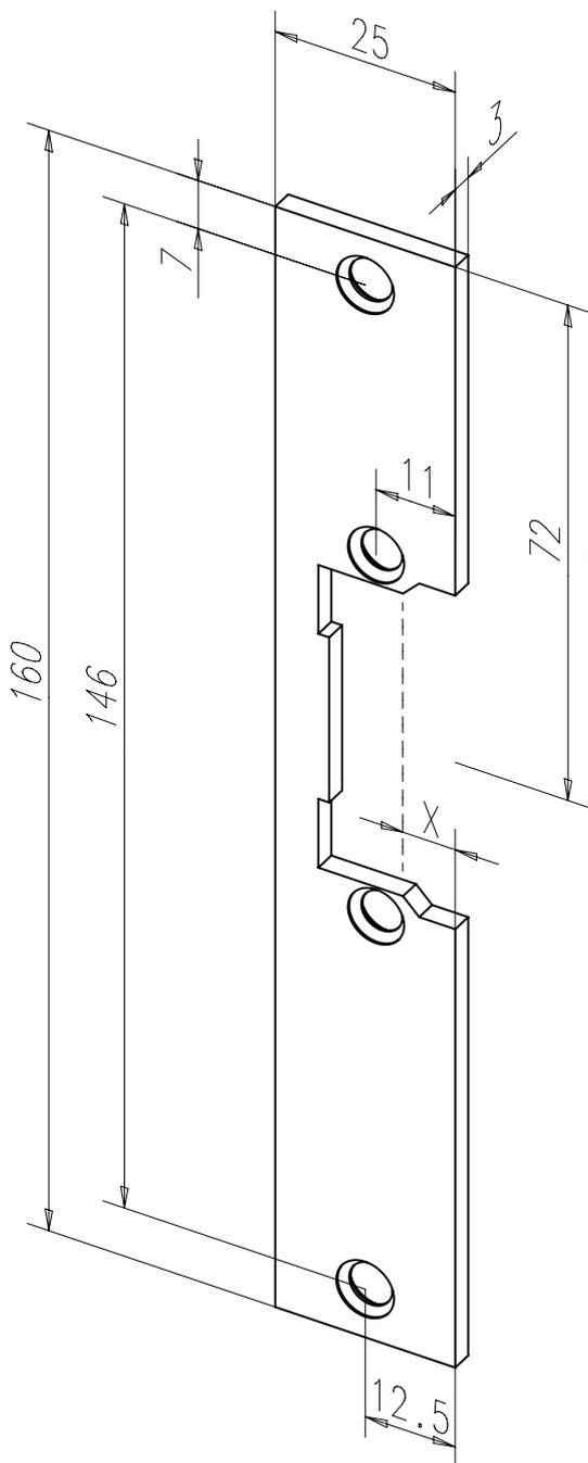
Kurzes Flachschießblech mit Fallenausschnitt.
