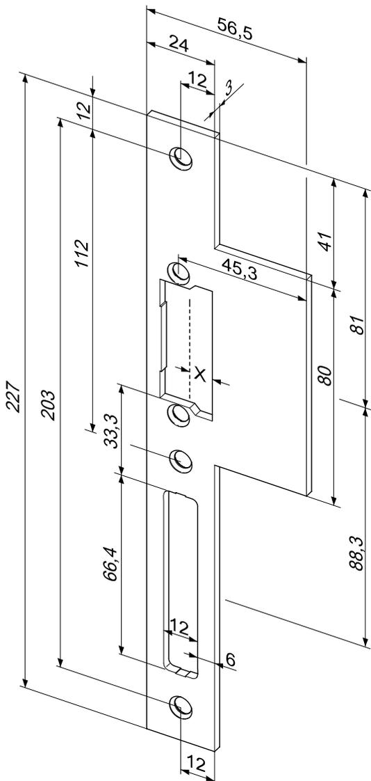
ProFix® 2 Lappenschließblech mit Fallen- und Riegelausschnitt.
