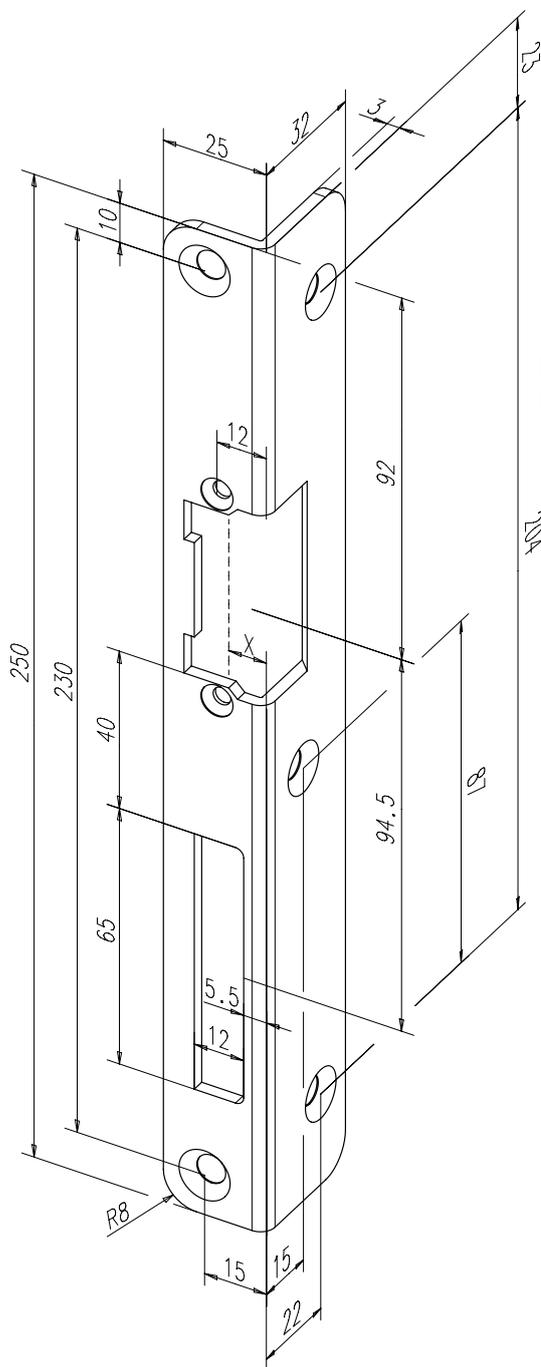
Sicherheits-Winkelschließblech mit Fallen- und Riegelausschnitt.
