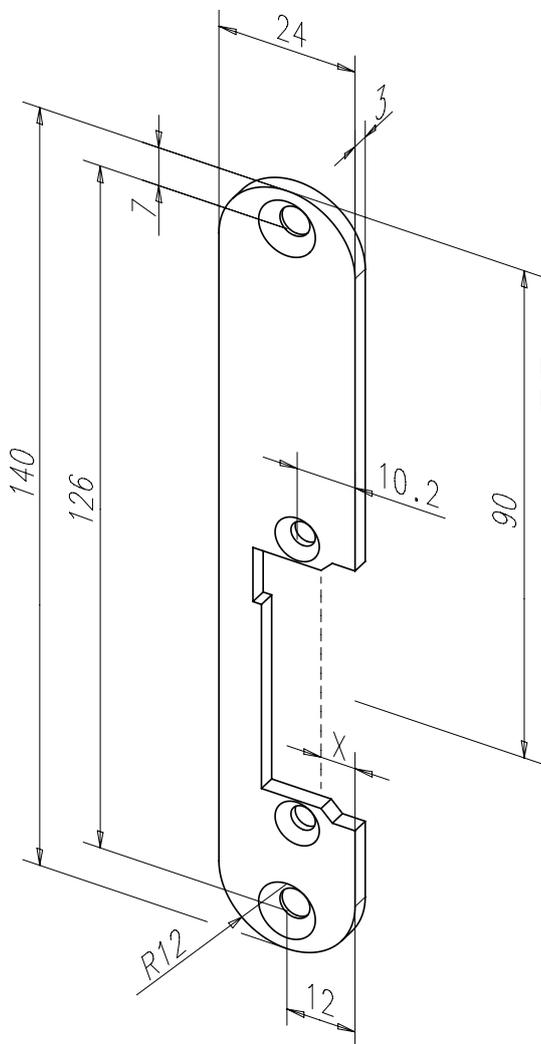
Kurzes Flachschießblech mit Fallenausschnitt.
