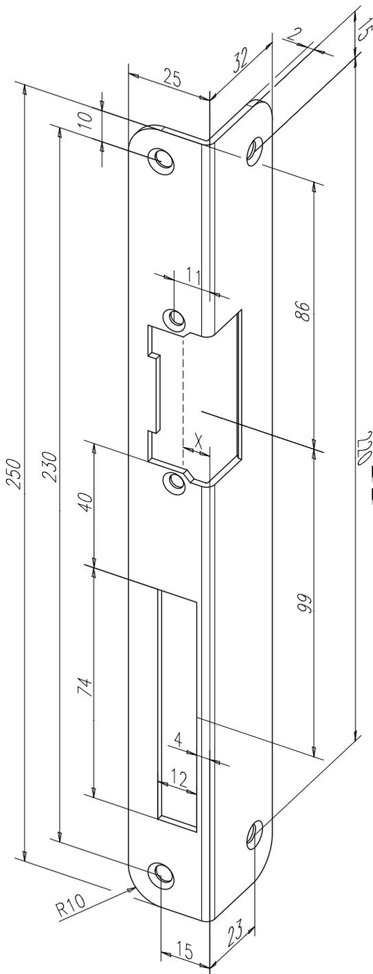
Standard-Winkelschließblech mit Fallen- und Riegelausschnitt.
