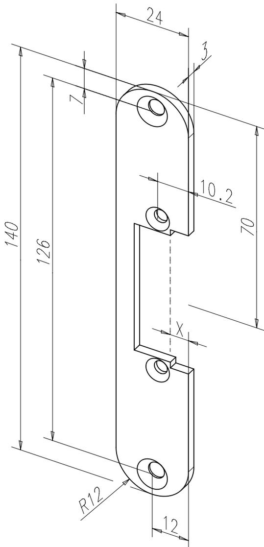
Kurzes Flachschießblech mit Fallenausschnitt.
