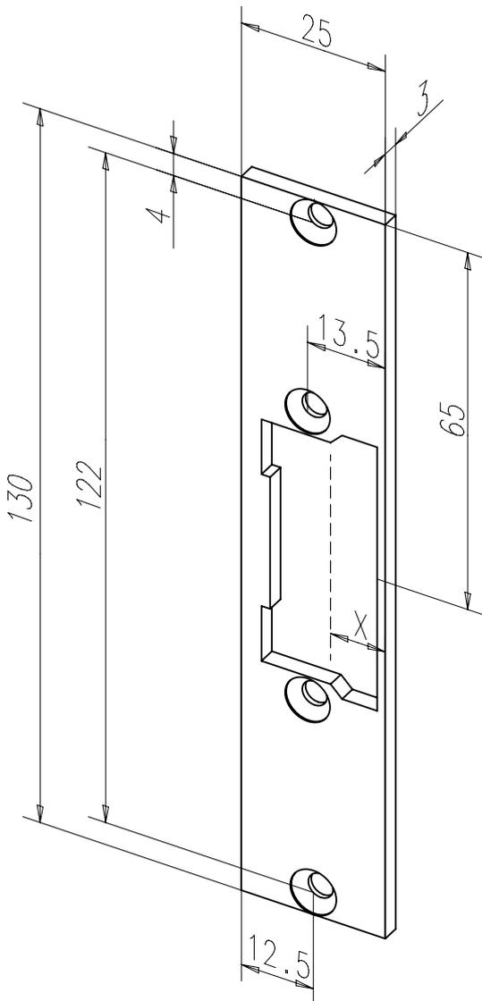
Kurzes Flachschließblech ohne Riegelausschnitt.
