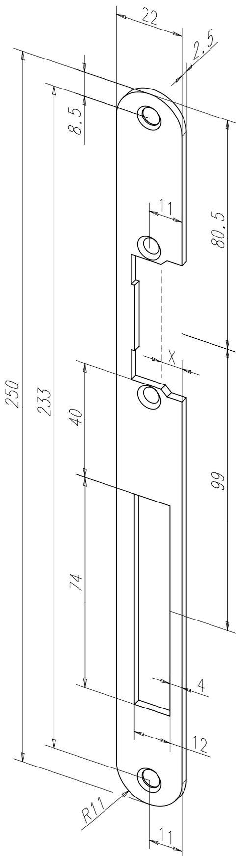
Flachschließblech mit Fallen- und Riegelausschnitt.
