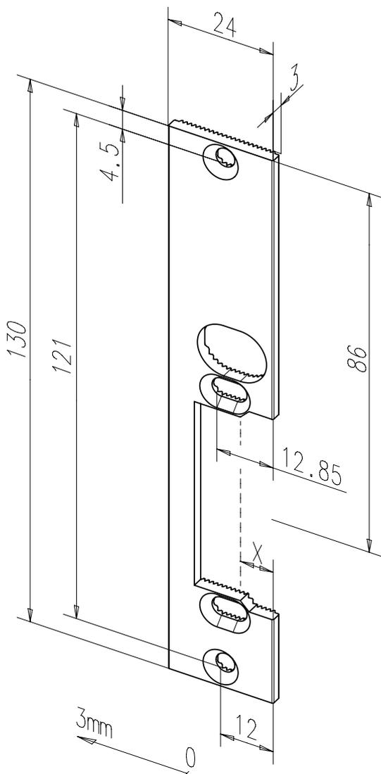
Kurzes Flachschießblech mit Fallenausschnitt.
