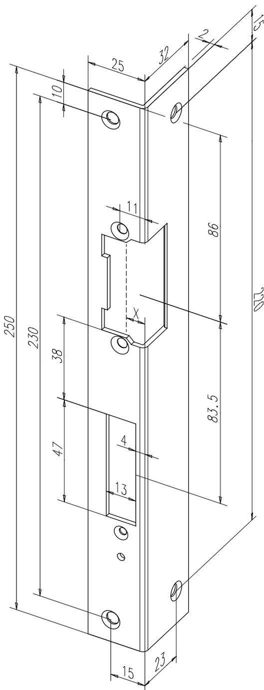
Standard - Winkelschließblech mit Fallen- und Riegelausschnitt.
