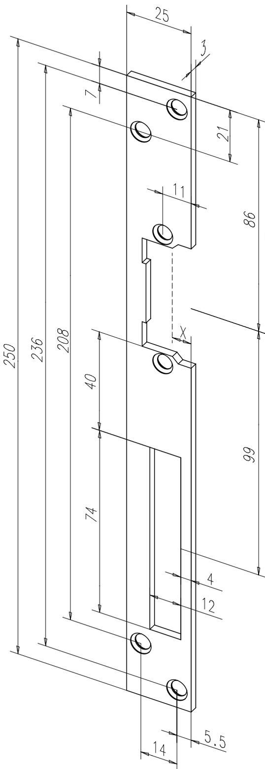
Standard-Flachschließblech mit Fallen- und Riegelausschnitt.
