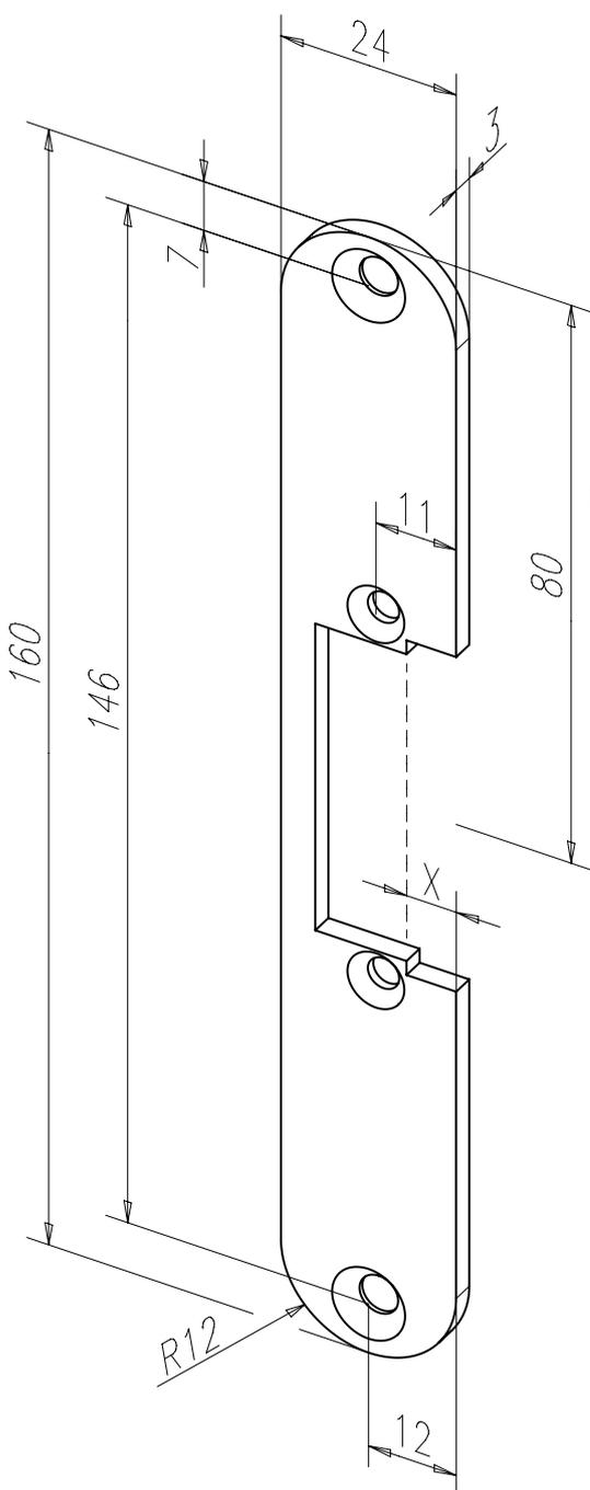
Kurzes Flachschießblech mit Fallenausschnitt.
