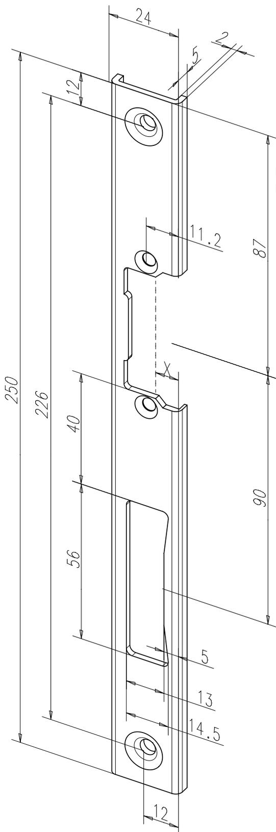
Flachschließblech mit Fallen- und Riegelausschnitt.
