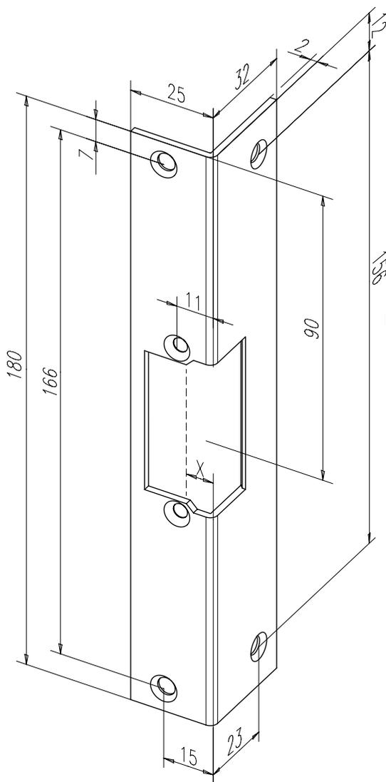
Kurzes Winkelschließblech mit Fallenausschnitt.
