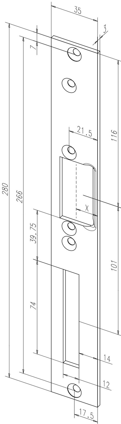
Flachschließblech mit Fallen- und Riegelausschnitt.
