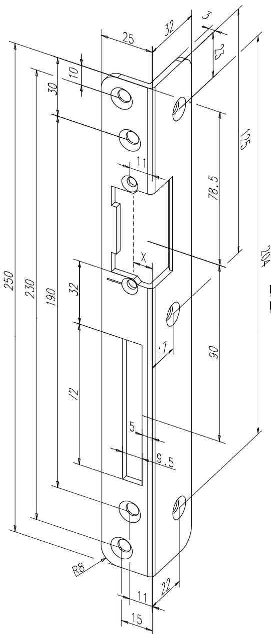
Sicherheits - Winkelschließblech mit Fallen- und Riegelausschnitt.
