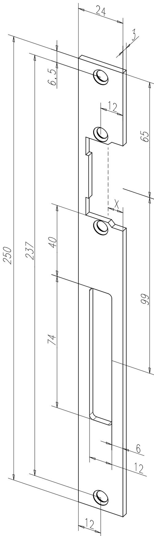
Flachschließblech mit Fallen- und Riegelausschnitt.
