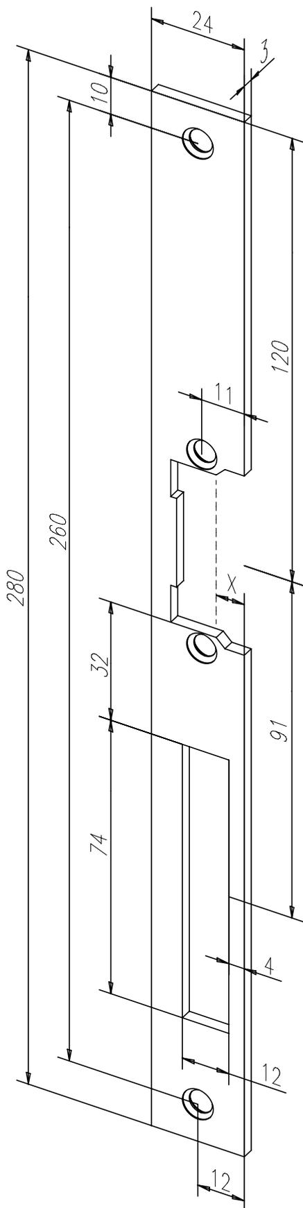
Flachschließblech mit Fallen- und Riegelausschnitt.
