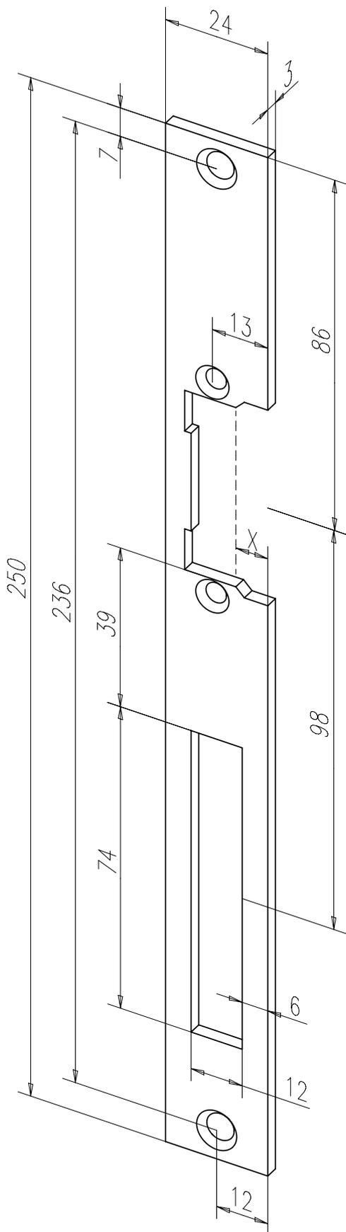
Standard-Flachschließblech mit Fallen- und Riegelausschnitt.
