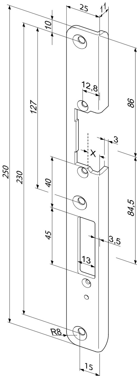
Winkelschließblech mit Fallen- und Riegelausschnitt.
