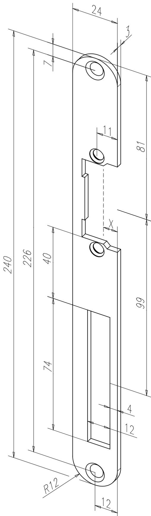
Flachschließblech mit Fallen- und Riegelausschnitt.
