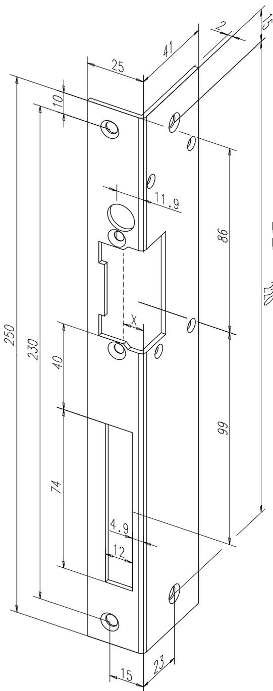
Standard - Winkelschließblech mit Fallen- und Riegelausschnitt.
