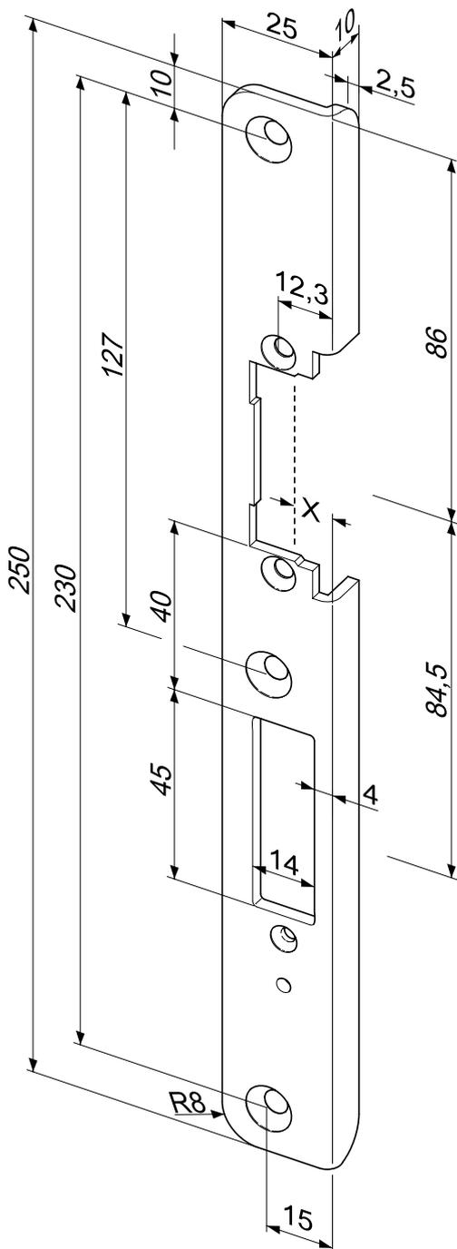
ProFix® 2 Winkelschließblech mit Fallen- und Riegelausschnitt.
