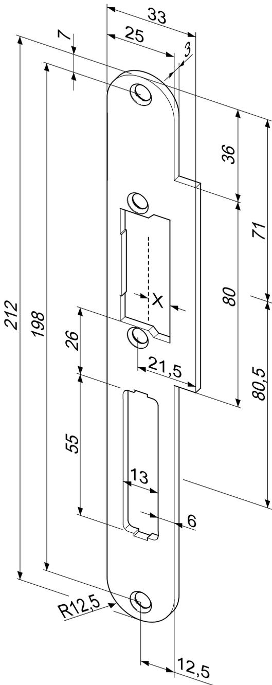
ProFix® 2 Flachschließblech mit Fallen- und Riegelausschnitt.
