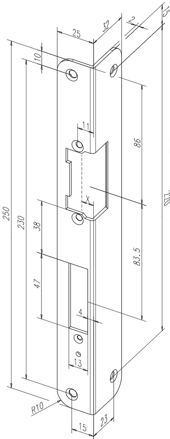
Standard-Winkelschließblech mit Fallen- und Riegelausschnitt.
