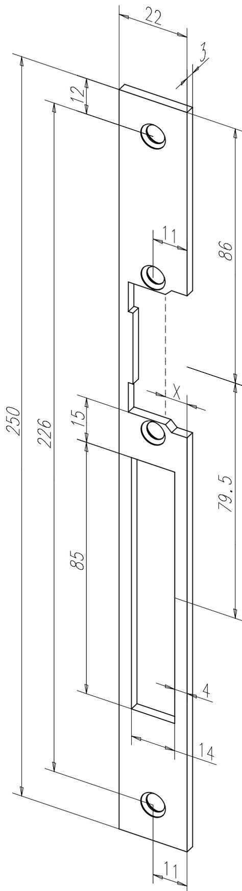
Flachschließblech mit Fallen- und Riegelausschnitt.
