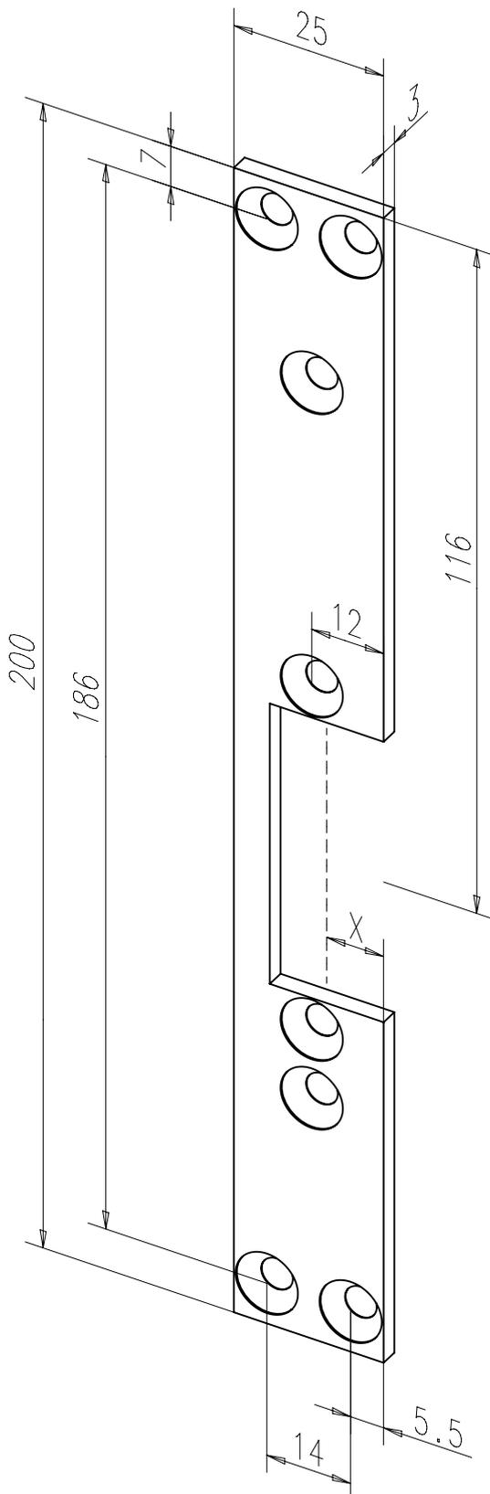
Kurzes Flachschließblech mit Fallenausschnitt.
