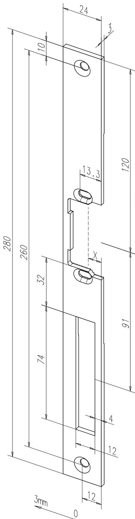
Flachschließblech mit Fallen- und Riegelausschnitt.
