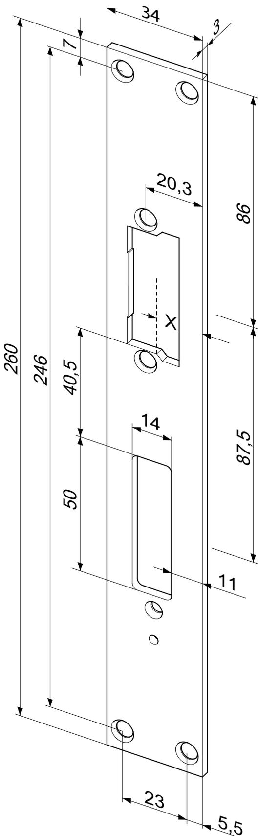
Flachschießblech mit Fallen- und Riegelausschnitt.
