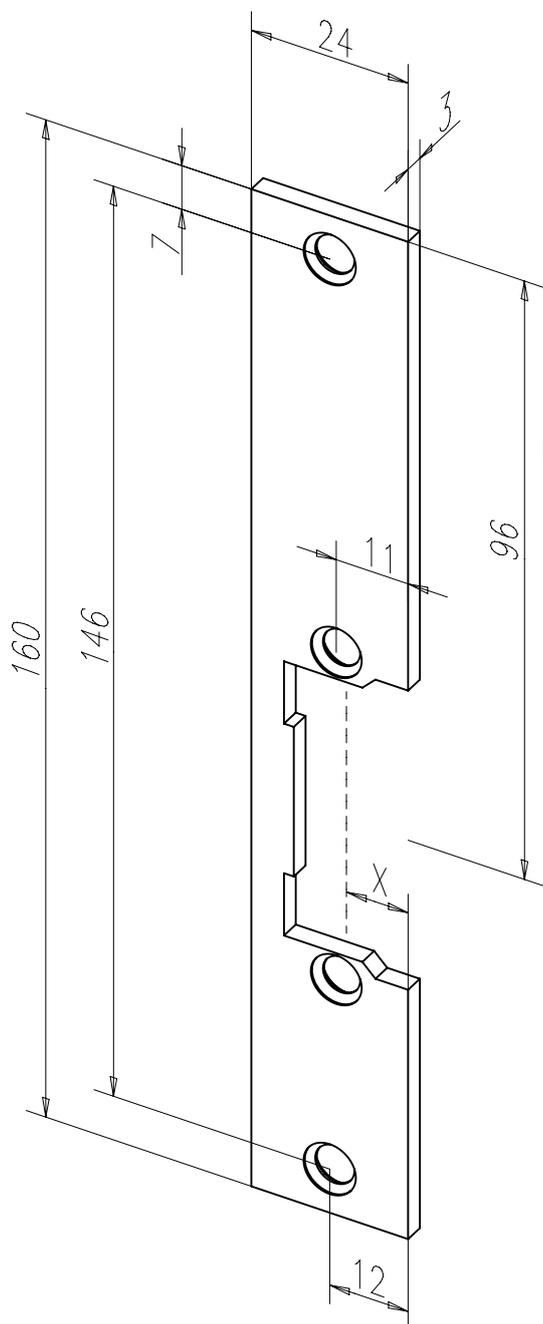
Kurzes Flachschießblech mit Fallenausschnitt.
