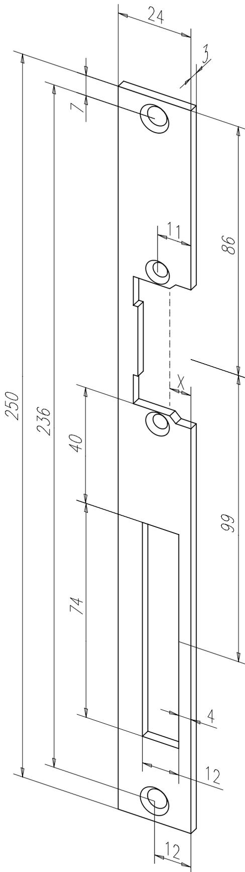
Flachschließblech mit Fallen- und Riegelausschnitt.
