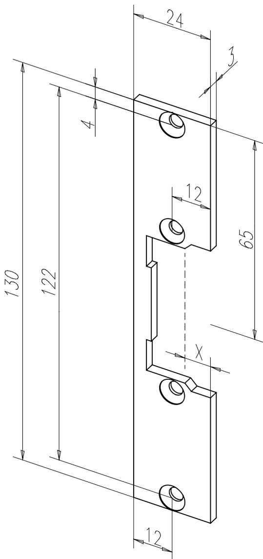
Kurzes Flachschließblech mit Fallenausschnitt.
