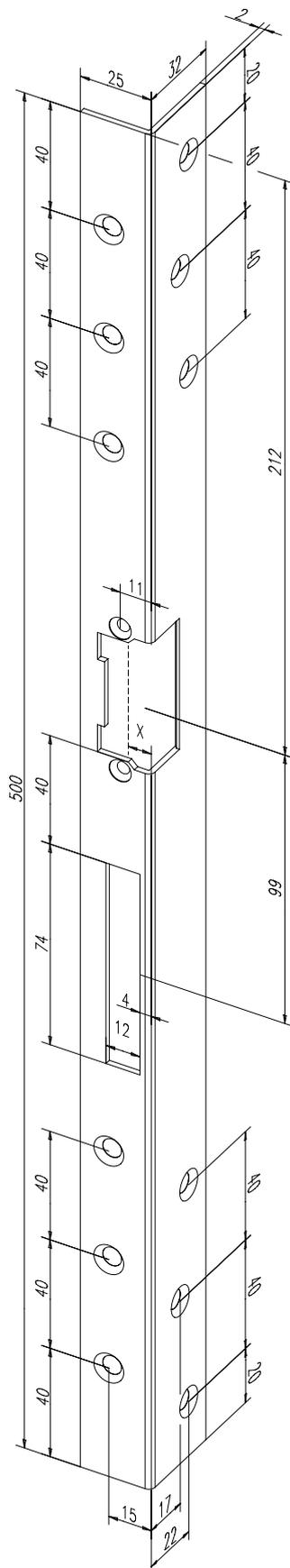
Winkelschließblech mit Fallen- und Riegelausschnitt.
