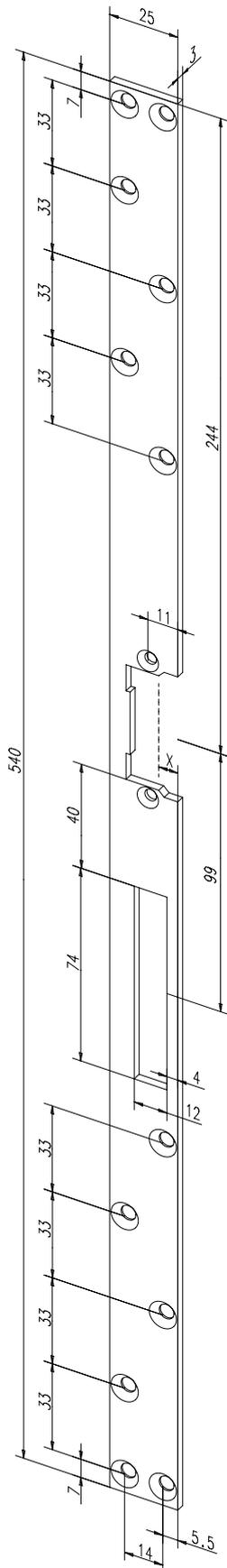
Sicherheits-Flachschließblech mit Fallen- und Riegelausschnitt.
