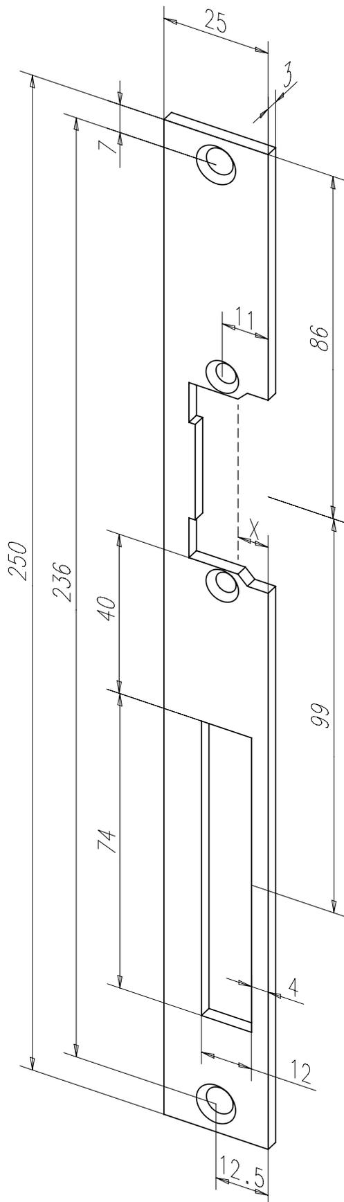
Flachschließblech mit Fallen- und Riegelausschnitt.
