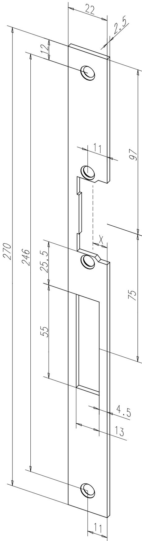
Flachschließblech mit Fallen- und Riegelausschnitt.
