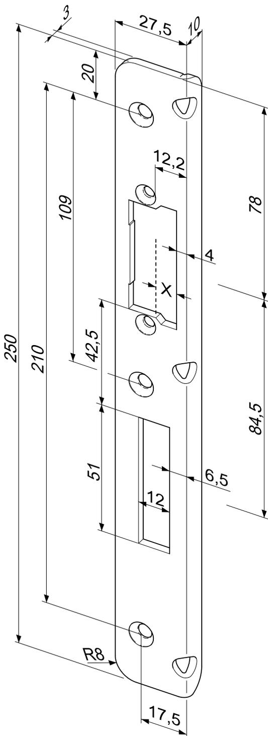
ProFix® 2 Winkelschließblech mit Fallen- und Riegelausschnitt.
