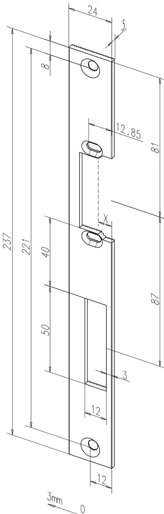
Flachschließblech mit Fallen- und Riegelausschnitt.
