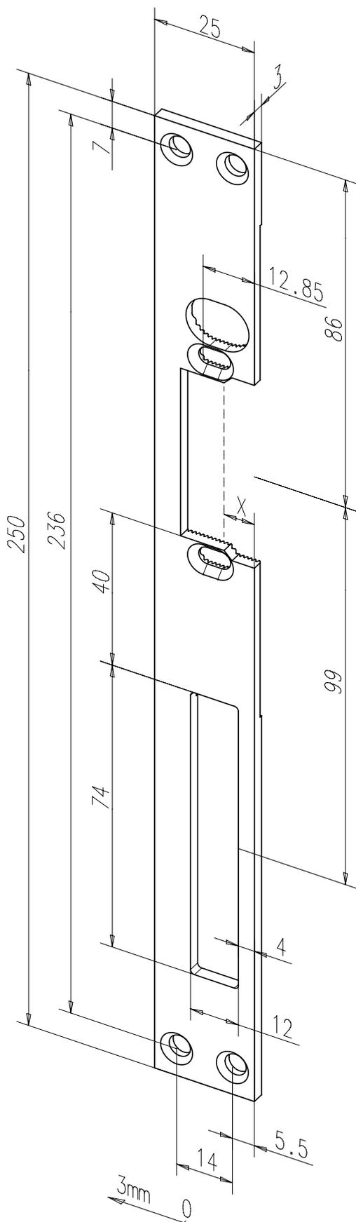
Flachschließblech mit Fallen- und Riegelausschnitt.
