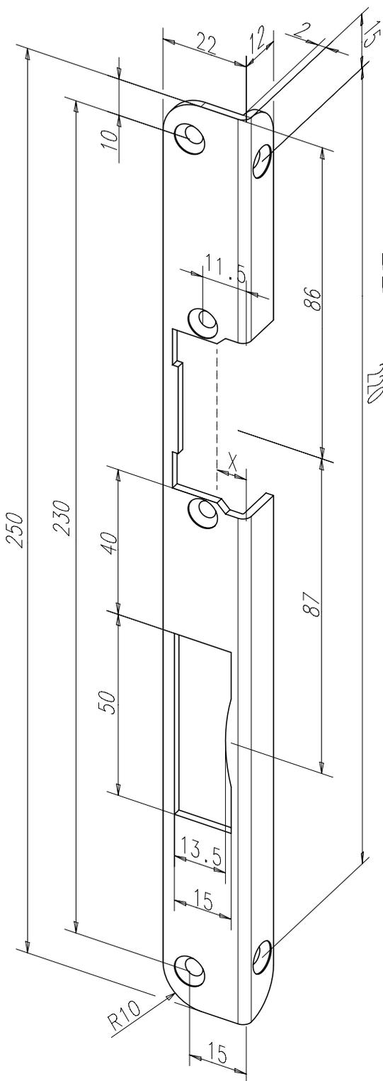
Standard - Winkelschließblech mit Fallen- und Riegelausschnitt.
