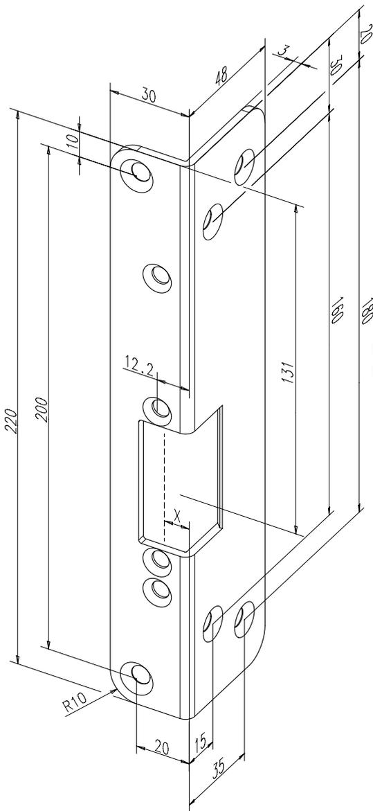
Kurzes Winkelschließblech mit Fallenausschnitt.
