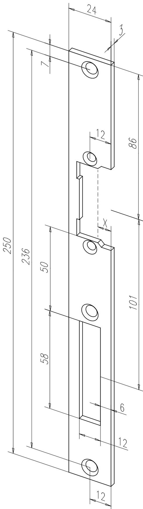
Standard-Flachschließblech mit Fallen- und Riegelausschnitt.
