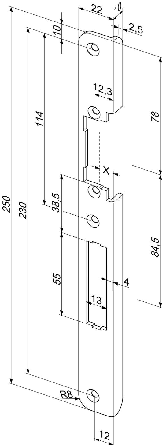
ProFix® 2 Winkelschließblech mit Fallen- und Riegelausschnitt.
