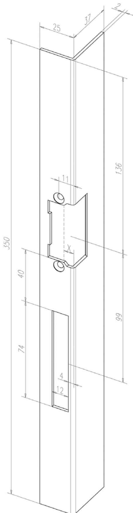
Winkelschließblech mit Fallen- und Riegelausschnitt, ohne Befestigungslöcher.
