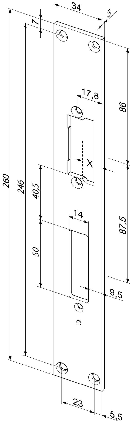
ProFix® 2 Flachschließblech mit Fallen- und Riegelausschnitt.
