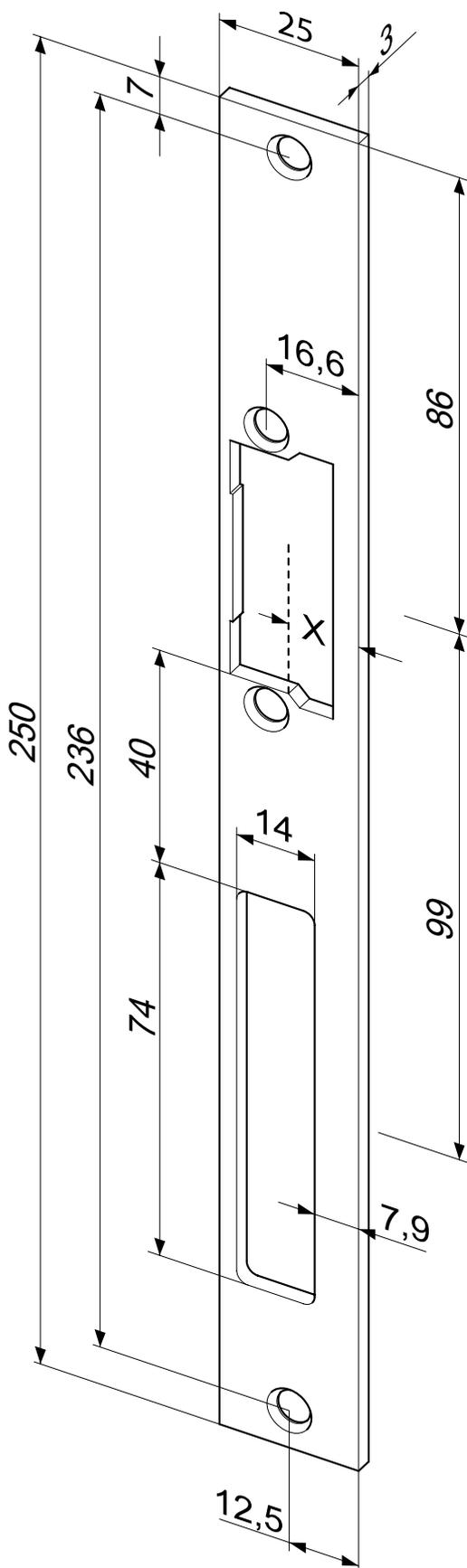
Flachschießblech mit Fallen- und Riegelausschnitt.
