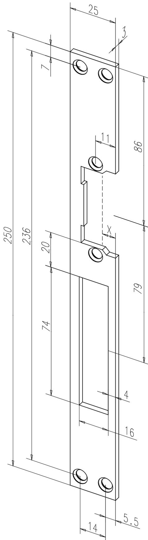
Standard-Flachschließblech mit Fallen- und Riegelausschnitt.
