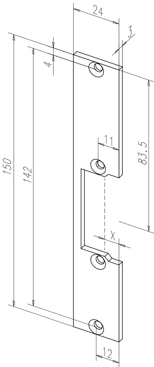
Kurzes Flachschießblech mit Fallenausschnitt.
