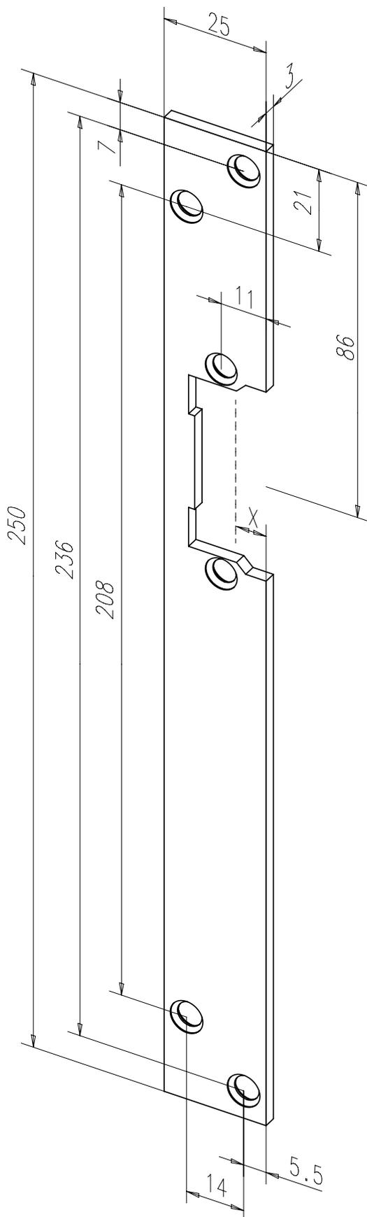
Standard-Flachschließblech mit Fallenausschnitt.
