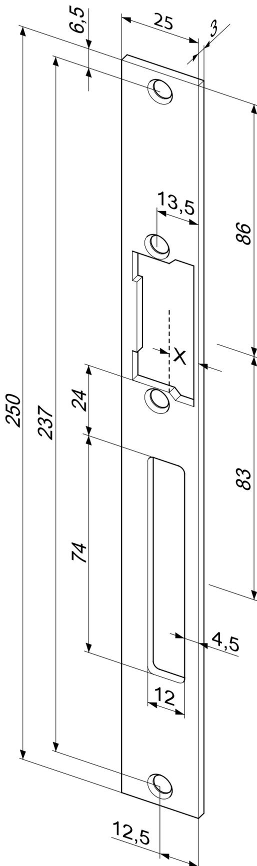
Flachschließblech mit Fallen- und Riegelausschnitt.
