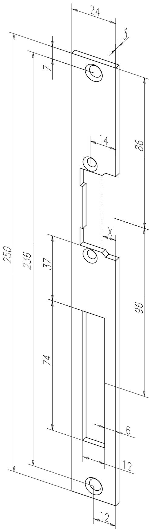
Standard-Flachschießblech mit Fallen- und Riegelausschnitt.
