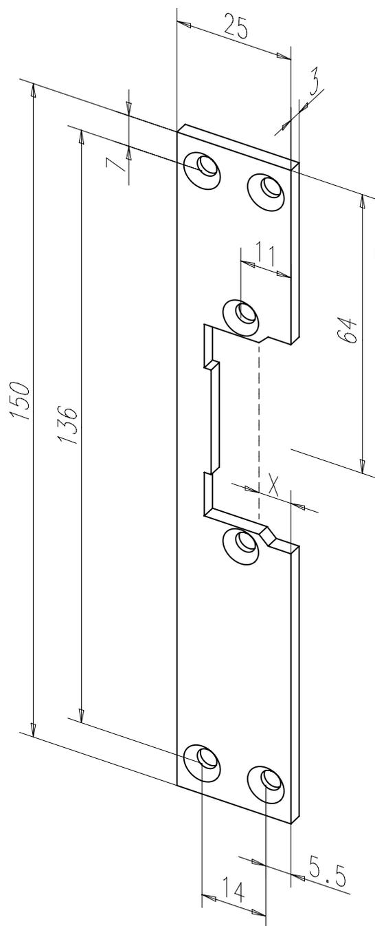
Kurzes Flachschießblech mit Fallenausschnitt.
