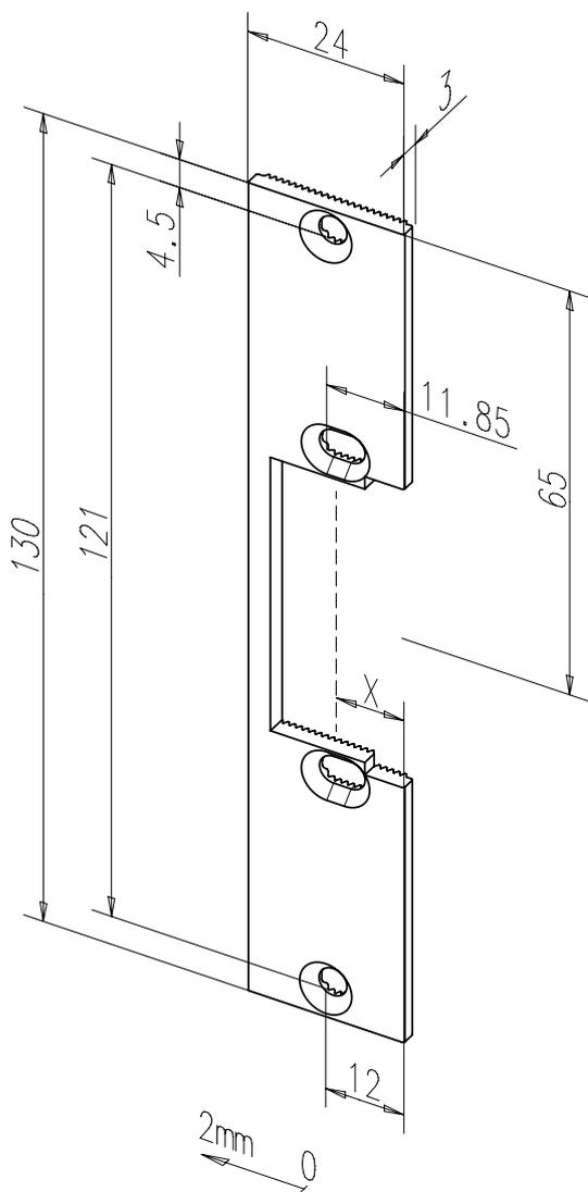
Kurzes Flachschießblech mit Fallenausschnitt.
