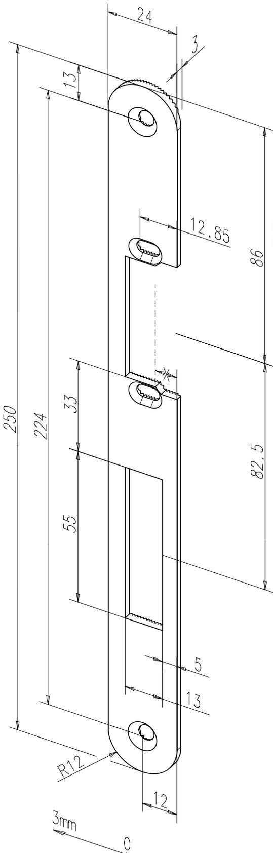
Standard-Flachschließblech mit Fallen- und Riegelausschnitt.
