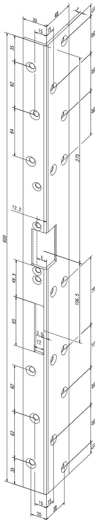
Sicherheits-Winkelschließblech mit Fallen- und Riegelausschnitt.
