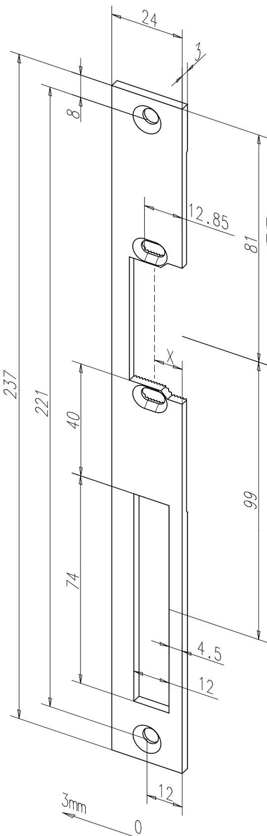
Flachschließblech mit Fallen- und Riegelausschnitt.
