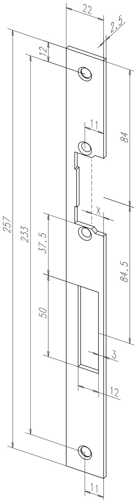
Flachschießblech mit Fallen- und Riegelausschnitt.
