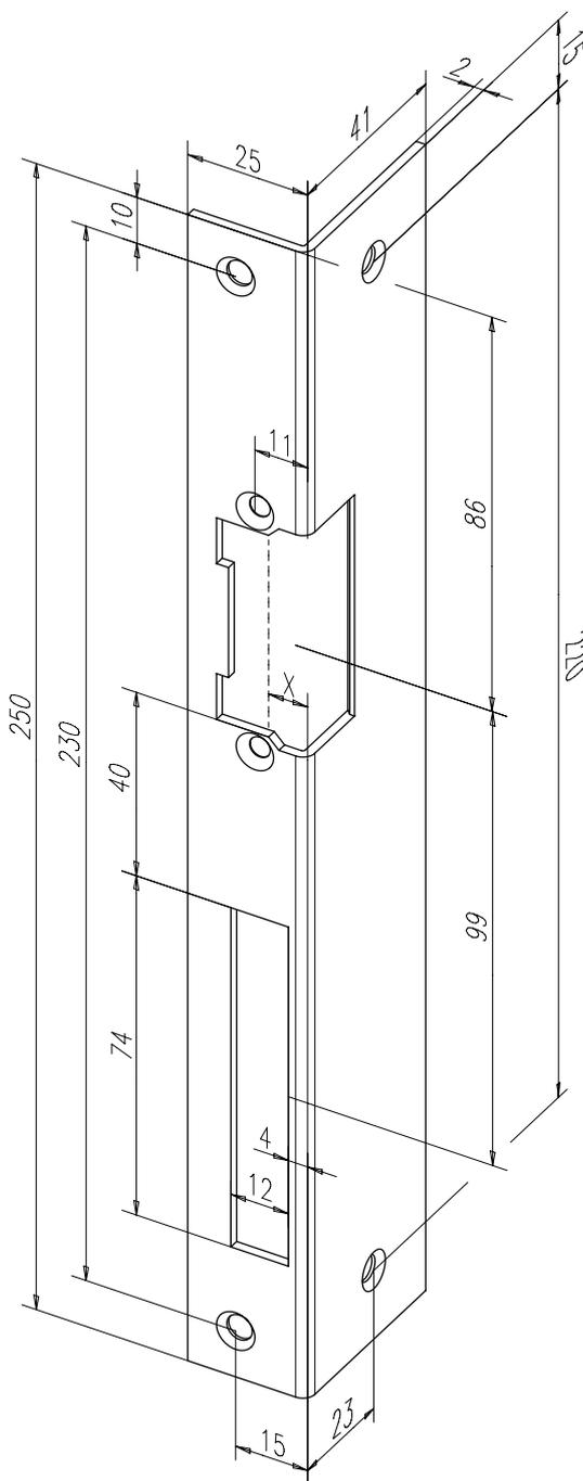
Winkelschließblech mit Fallen- und Riegelausschnitt.
