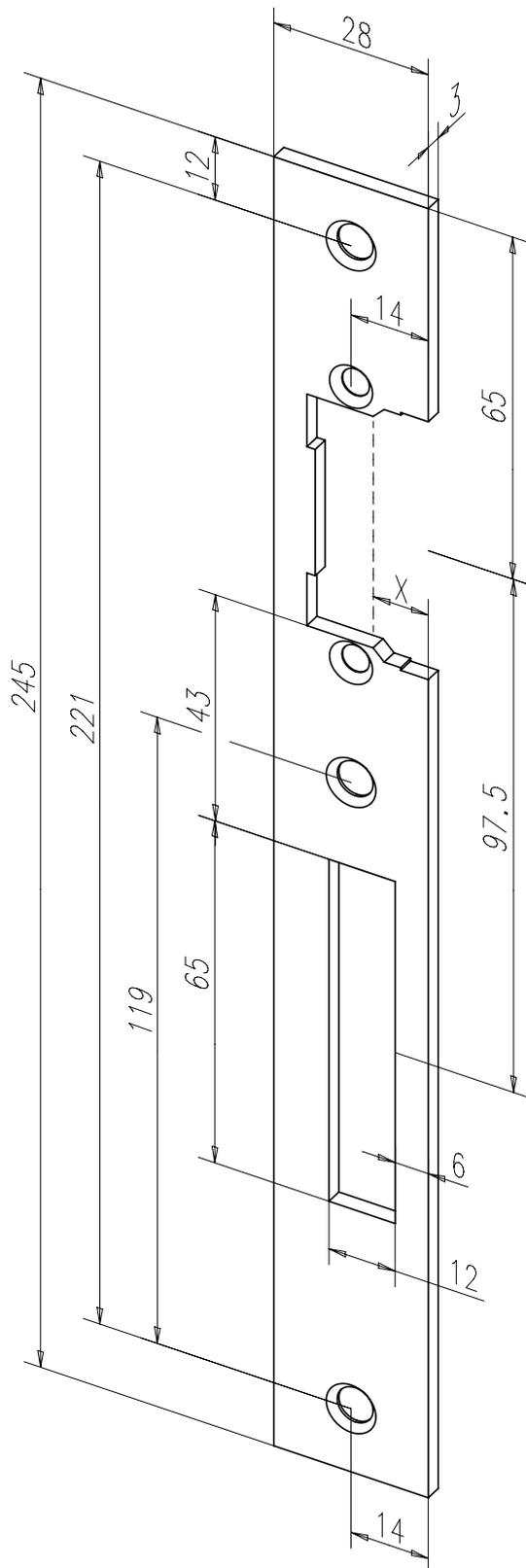
Flachschließblech mit Fallen- und Riegelausschnitt.
