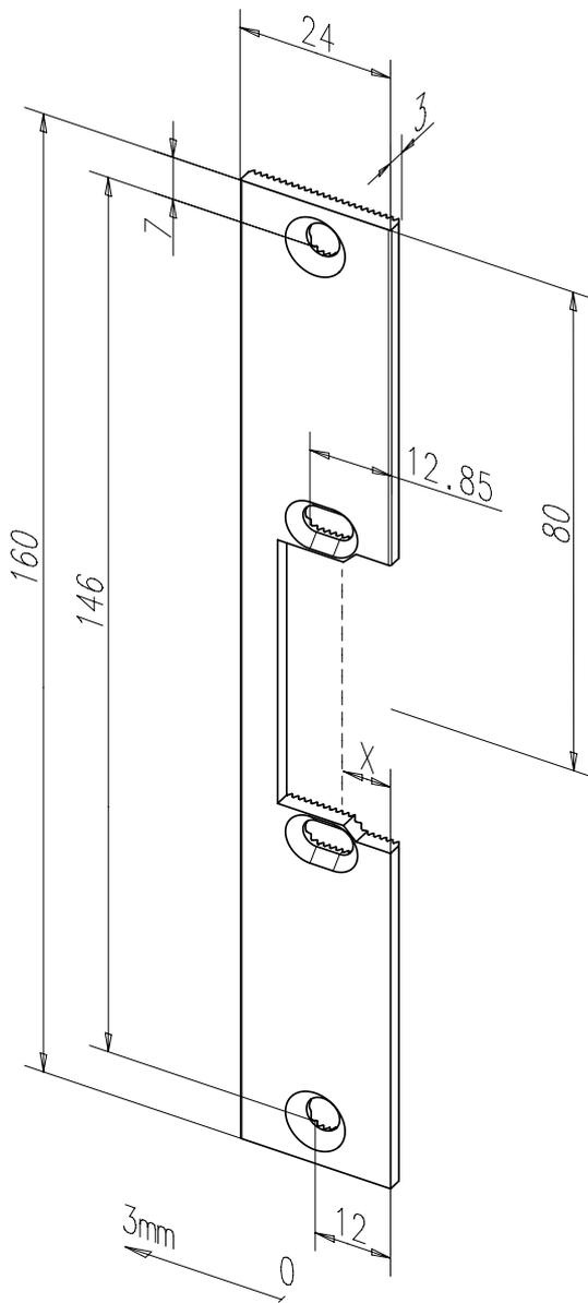
Kurzes Flachschießblech mit Fallenausschnitt.
