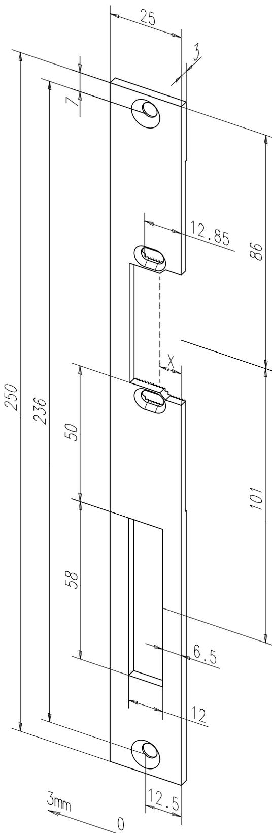
Flachschließblech mit Fallen- und Riegelausschnitt.
