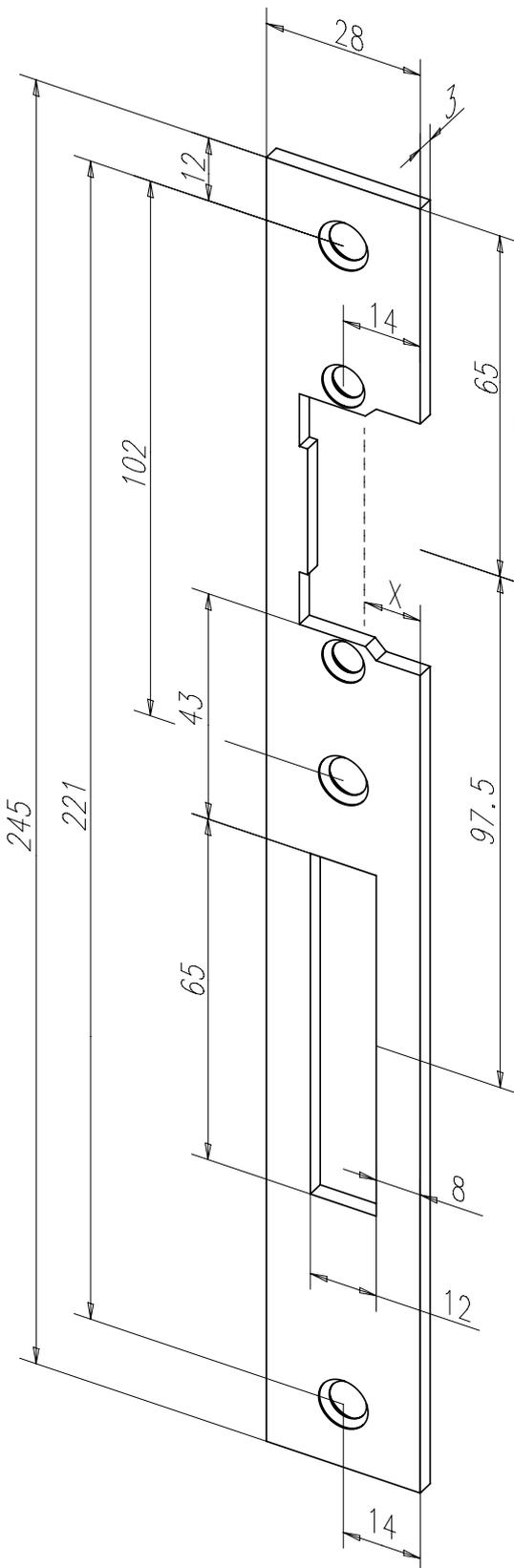
Flachschließblech mit Fallen- und Riegelausschnitt.
