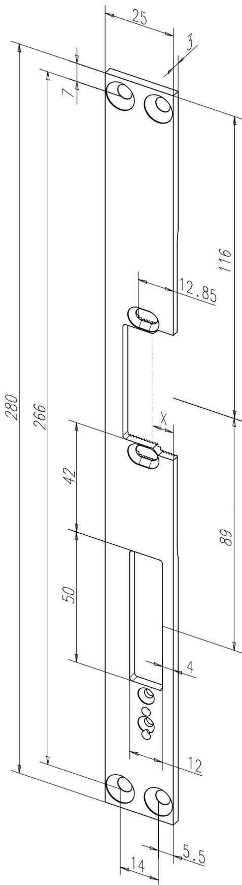
Flachschließblech mit Fallen- und Riegelausschnitt.
