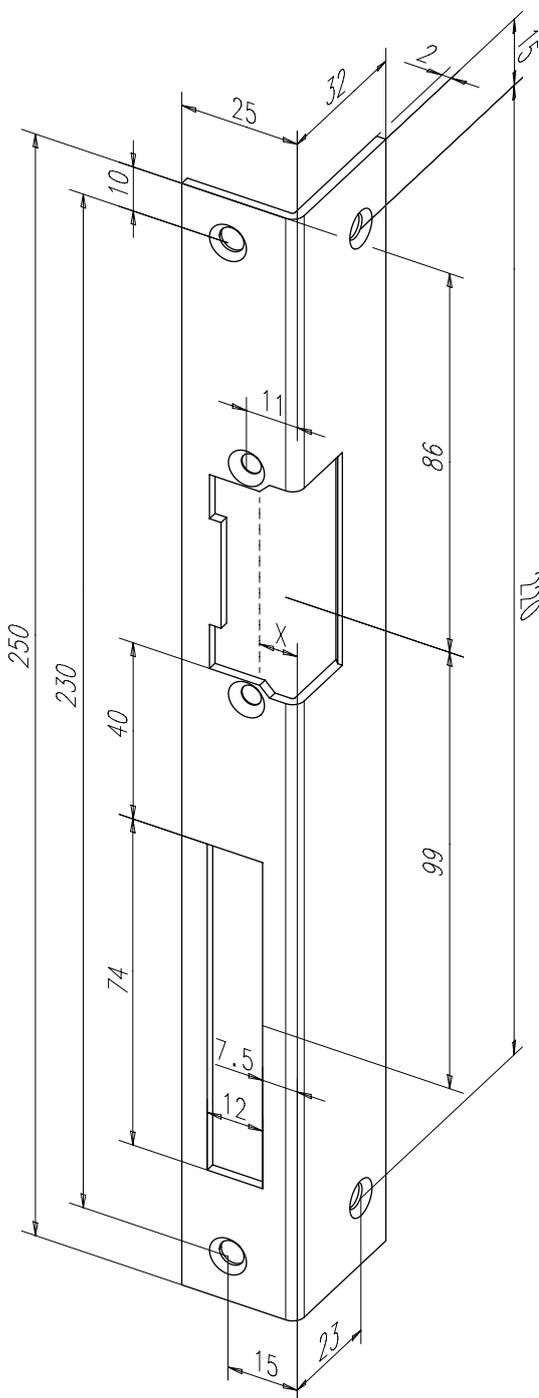
Standard - Winkelschließblech mit Fallen- und Riegelausschnitt.
