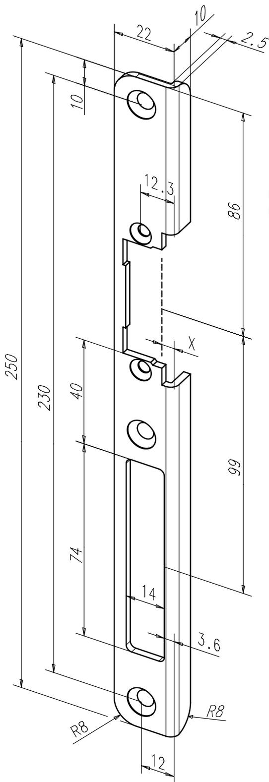
ProFix® 2 Winkelschließblech mit Fallen- und Riegelausschnitt.
