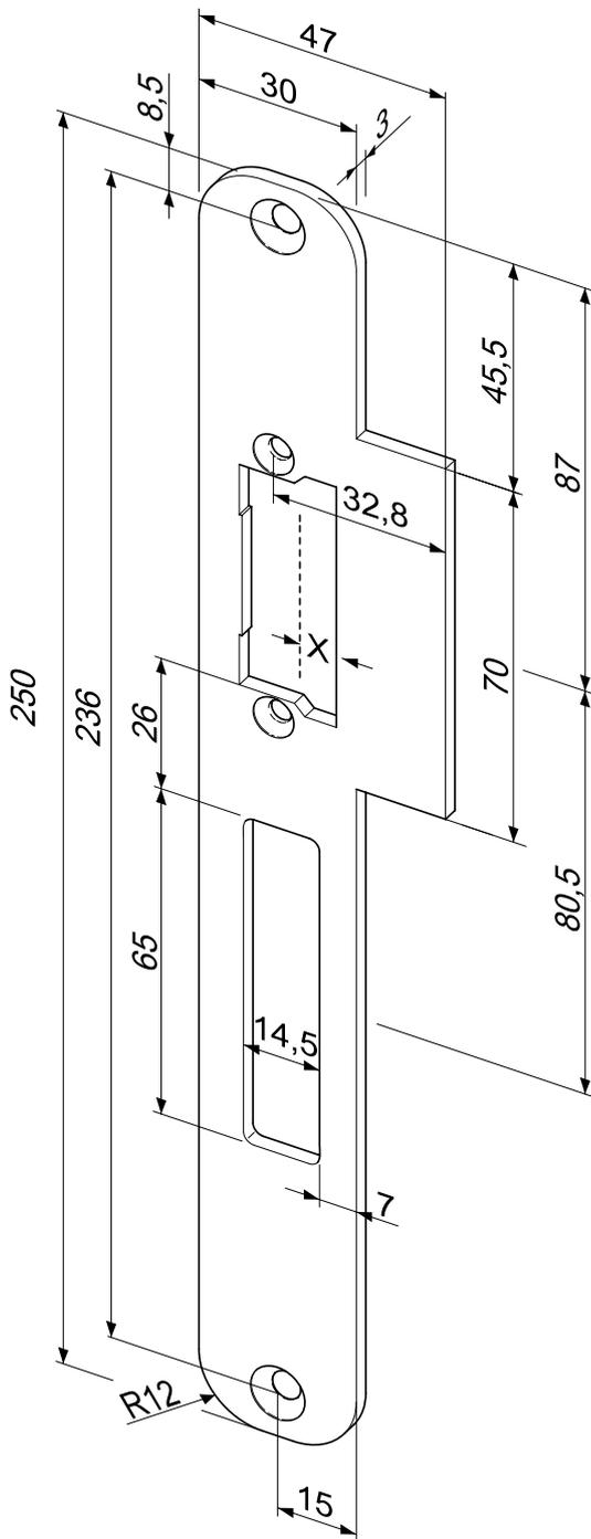
ProFix® 2 Flachschließblech mit Fallen- und Riegelausschnitt.
