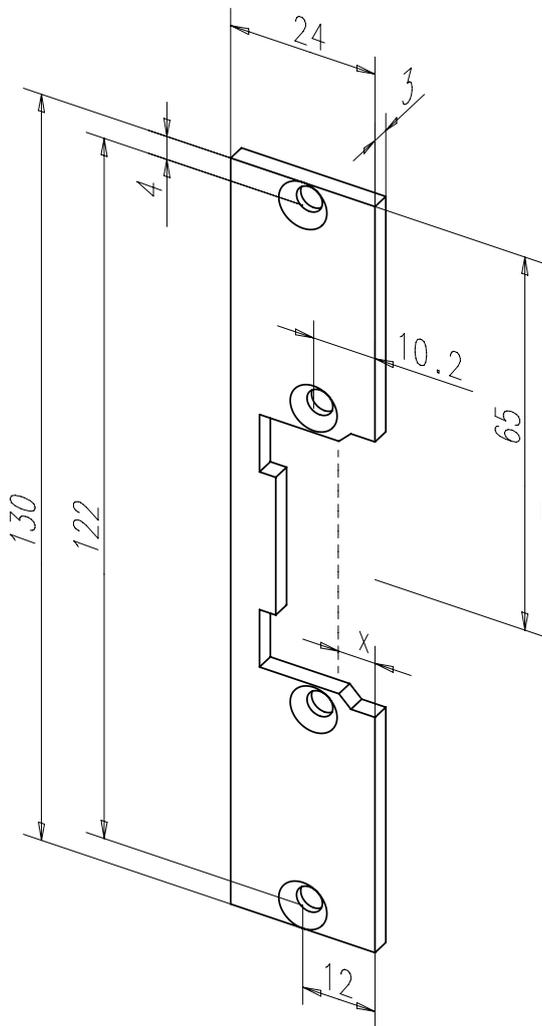
Kurzes Flachschießblech mit Fallenausschnitt.
