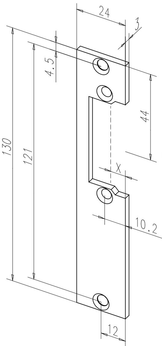
Kurzes Flachschießblech mit Fallenausschnitt.
