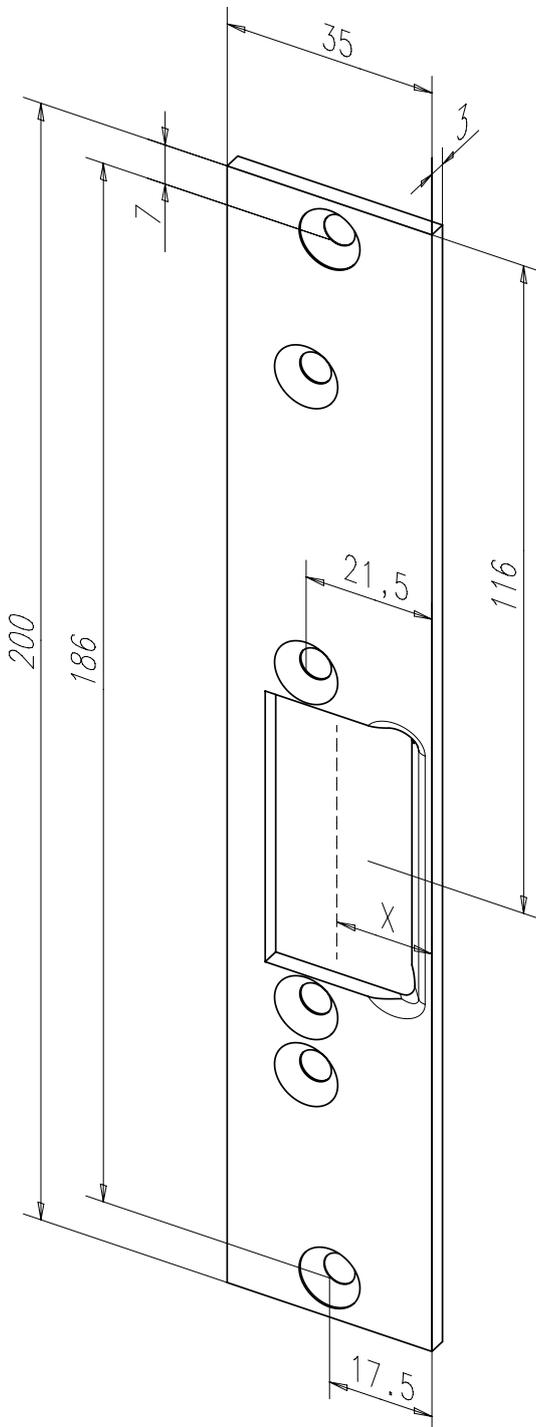
Kurzes Flachschließblech mit Fallenausschnitt.
