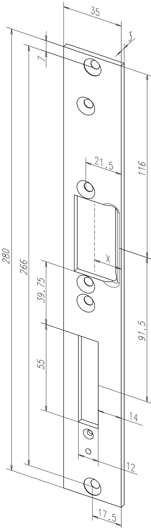
Flachschließblech mit Fallen- und Riegelausschnitt.
