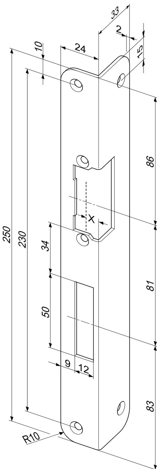
Winkelschließblech mit Fallen- und Riegelausschnitt.
