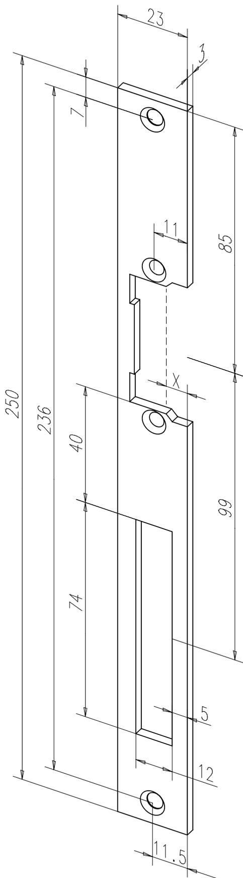
Flachschließblech mit Fallen- und Riegelausschnitt.
