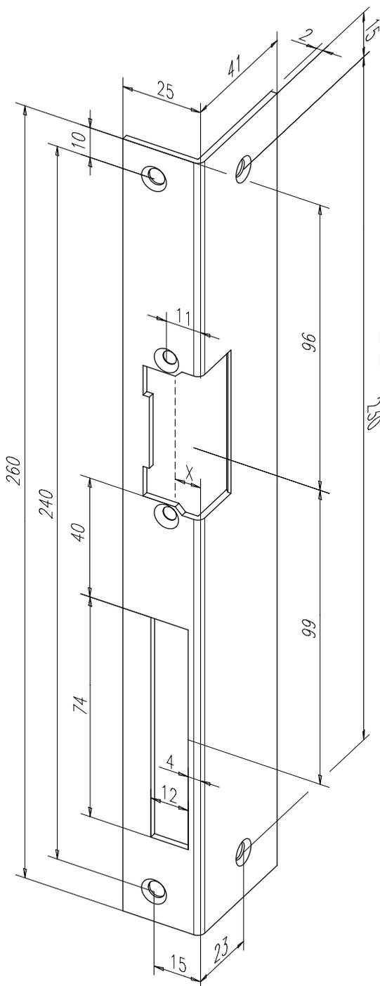
Winkelschließblech mit Fallen- und Riegelausschnitt.
