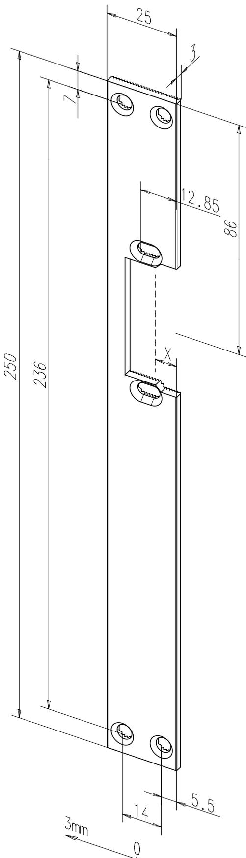
Flachschließblech mit Fallenausschnitt.
