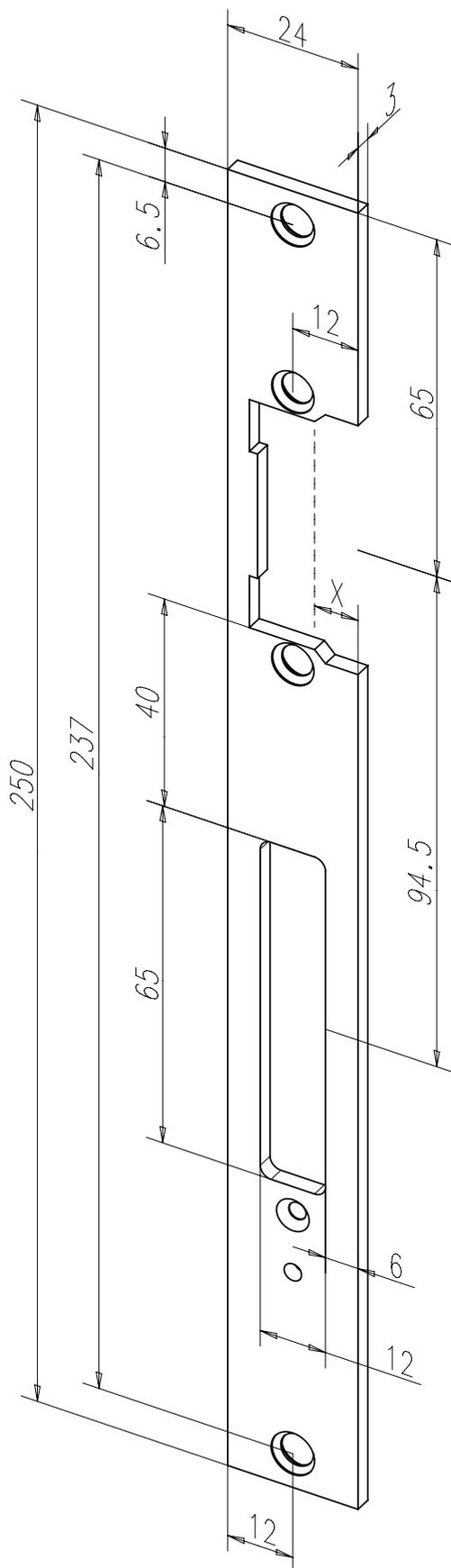
Langes Flachschließblech mit Fallenausschnitt
