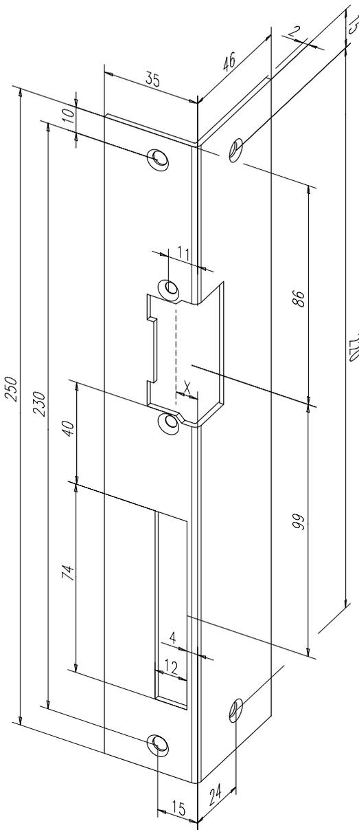
Winkelschließblech mit Fallen- und Riegelausschnitt.
