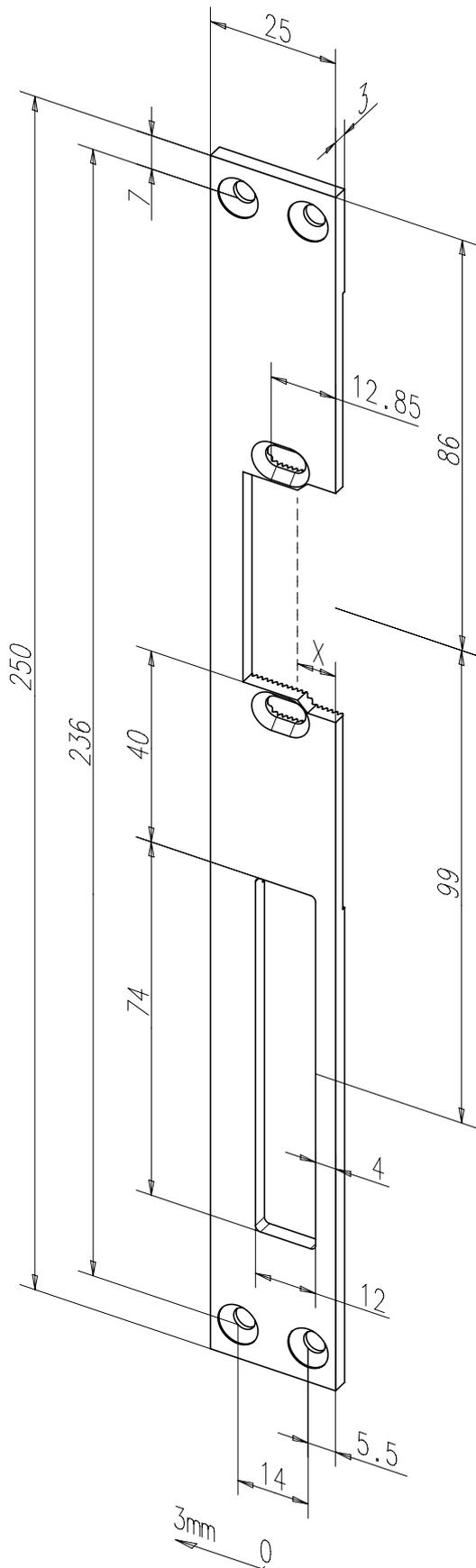
Flachschließblech mit Fallen- und Riegelausschnitt.
