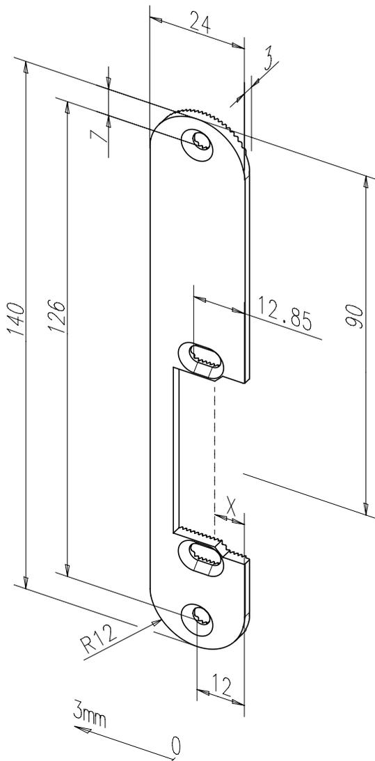
Kurzes Flachschießblech mit Fallenausschnitt.
