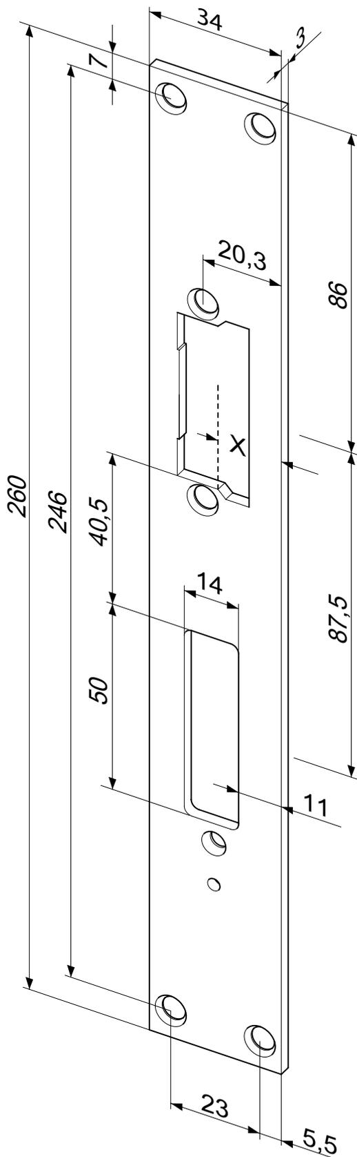
ProFix® 2 Flachschließblech mit Fallen- und Riegelausschnitt.
