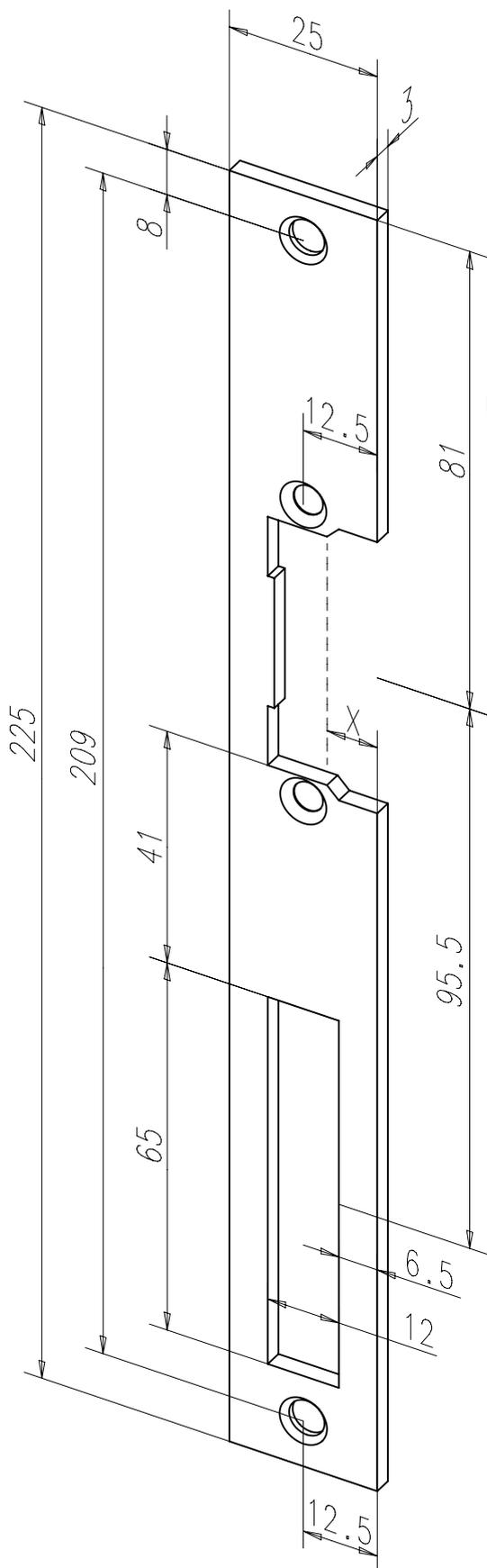
Flachschließblech mit Fallen- und Riegelausschnitt.
