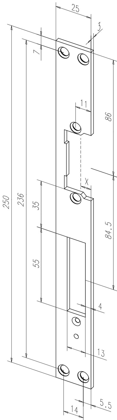
Flachschließblech mit Fallen- und Riegelausschnitt.
