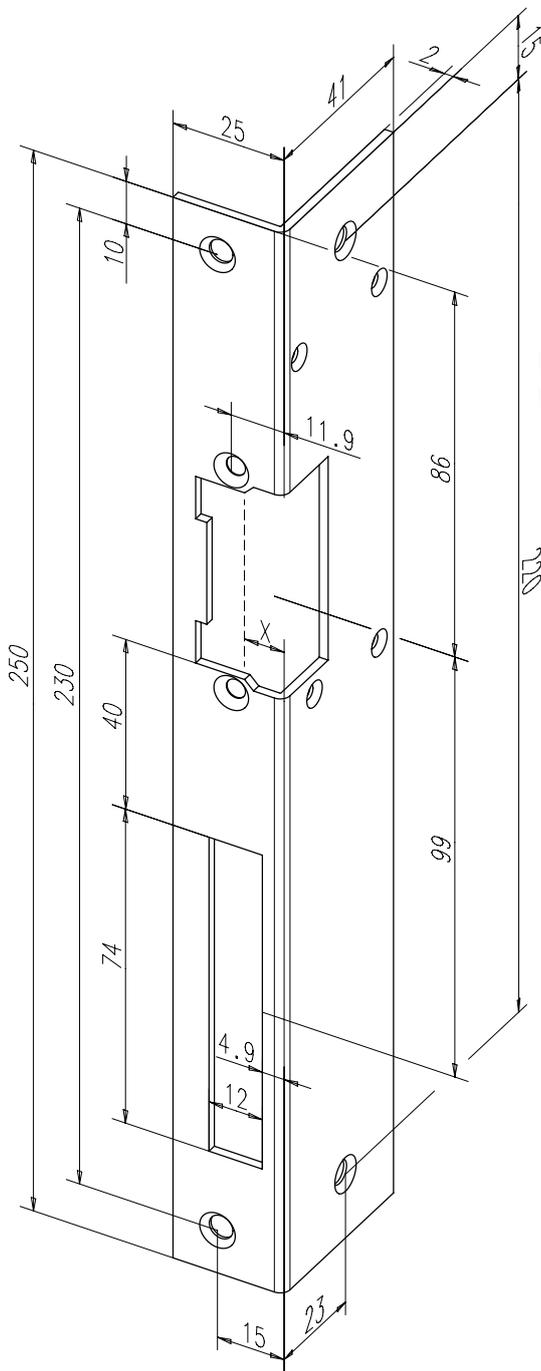
Standard - Winkelschließblech mit Fallen- und Riegelausschnitt.
