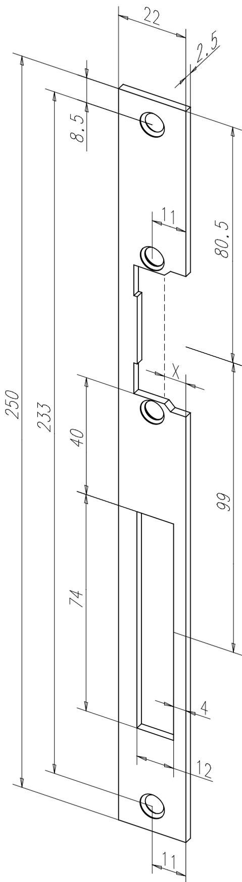
Flachschließblech mit Fallen- und Riegelausschnitt.
