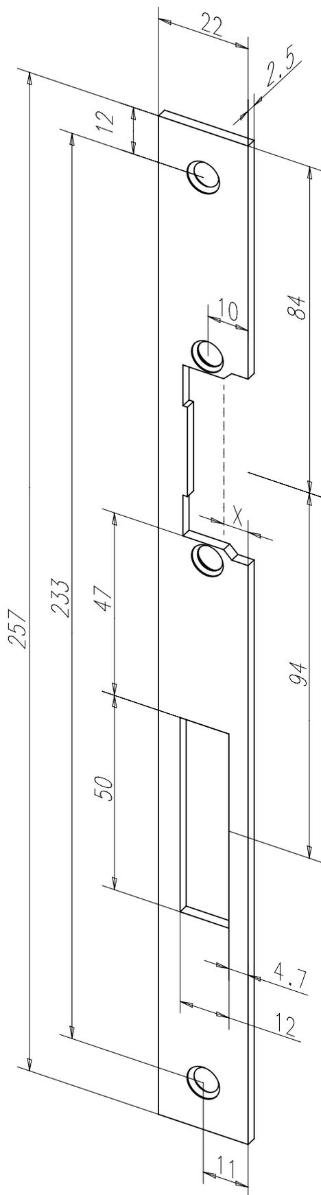
Flachschließblech mit Fallen- und Riegelausschnitt.
