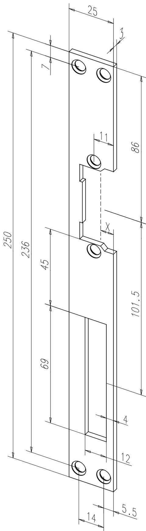
Standard-Flachschließblech mit Fallen- und Riegelausschnitt.
