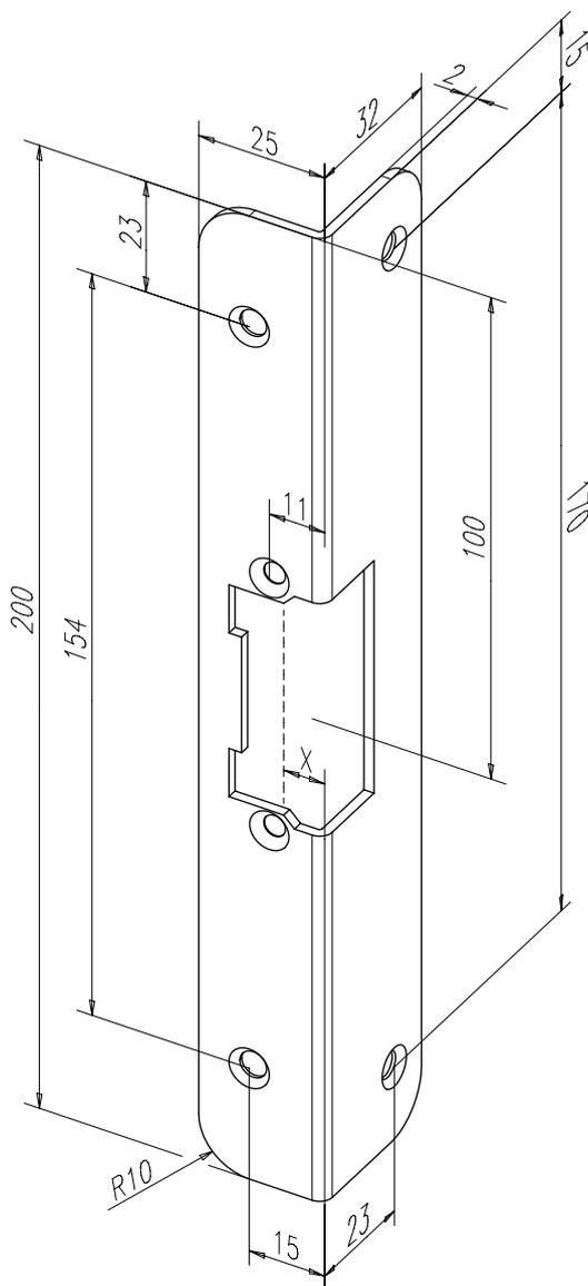
Kurzes Winkelschließblech mit Fallenausschnitt.
