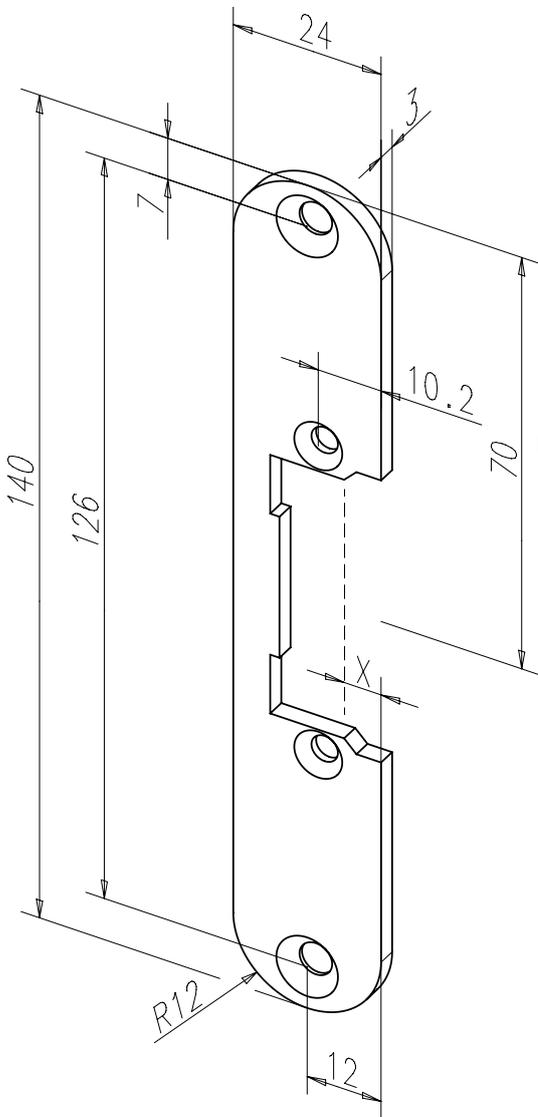
Kurzes Flachschießblech mit Fallenausschnitt.
