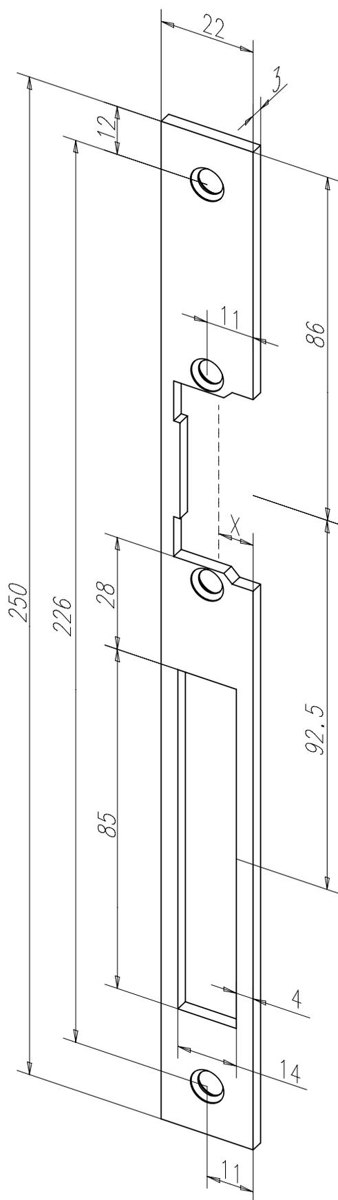
Flachschließblech mit Fallen- und Riegelausschnitt.
