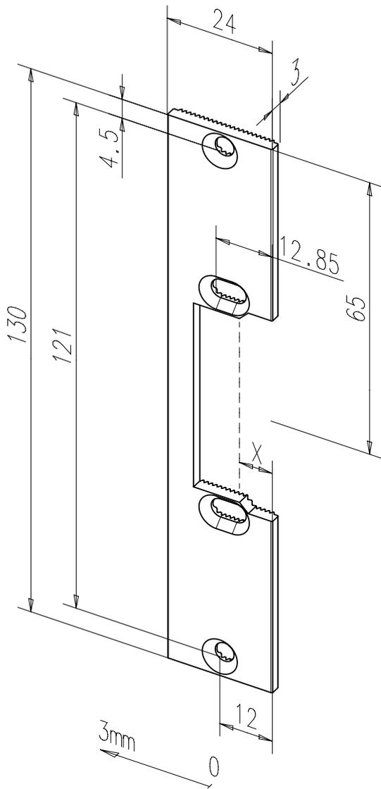
Kurzes Flachschießblech mit Fallenausschnitt.
