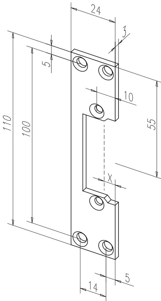
Kurzes Flachschießblech mit Fallenausschnitt.
