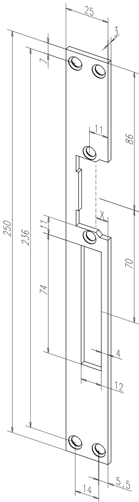
Standard-Flachschließblech mit Fallen- und Riegelausschnitt.
