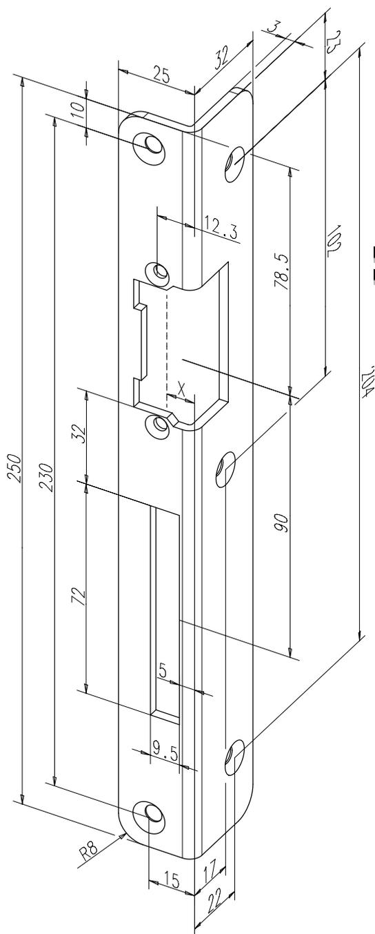
Sicherheits-Winkelschließblech mit Fallen- und Riegelausschnitt.
