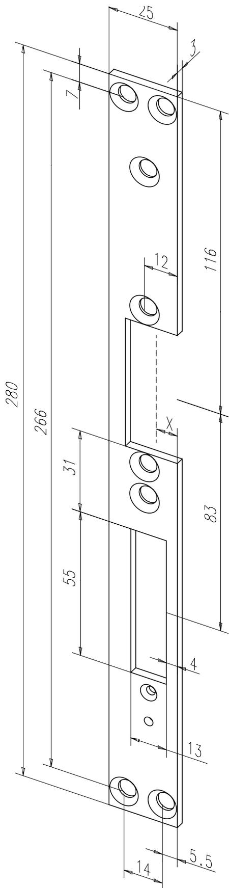
Flachschließblech mit Fallen- und Riegelausschnitt.
