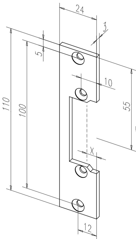
Kurzes Flachschießblech mit Fallenausschnitt.
