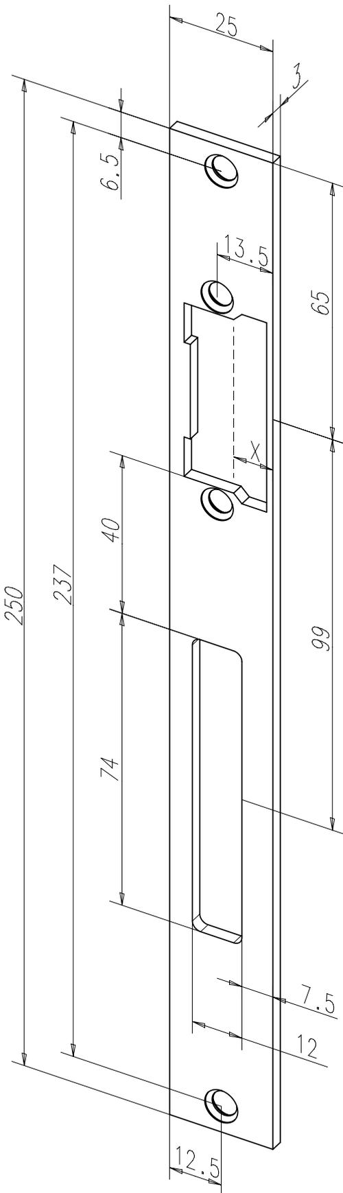
Flachschließblech mit Fallen- und Riegelausschnitt.
