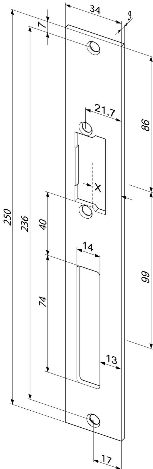
Flachschließblech mit Fallen- und Riegelausschnitt.
