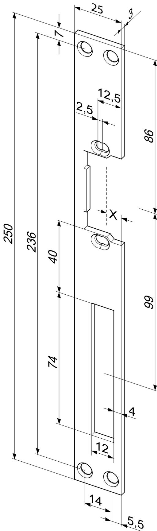
Flachschließblech mit Riegelausschnitt.
