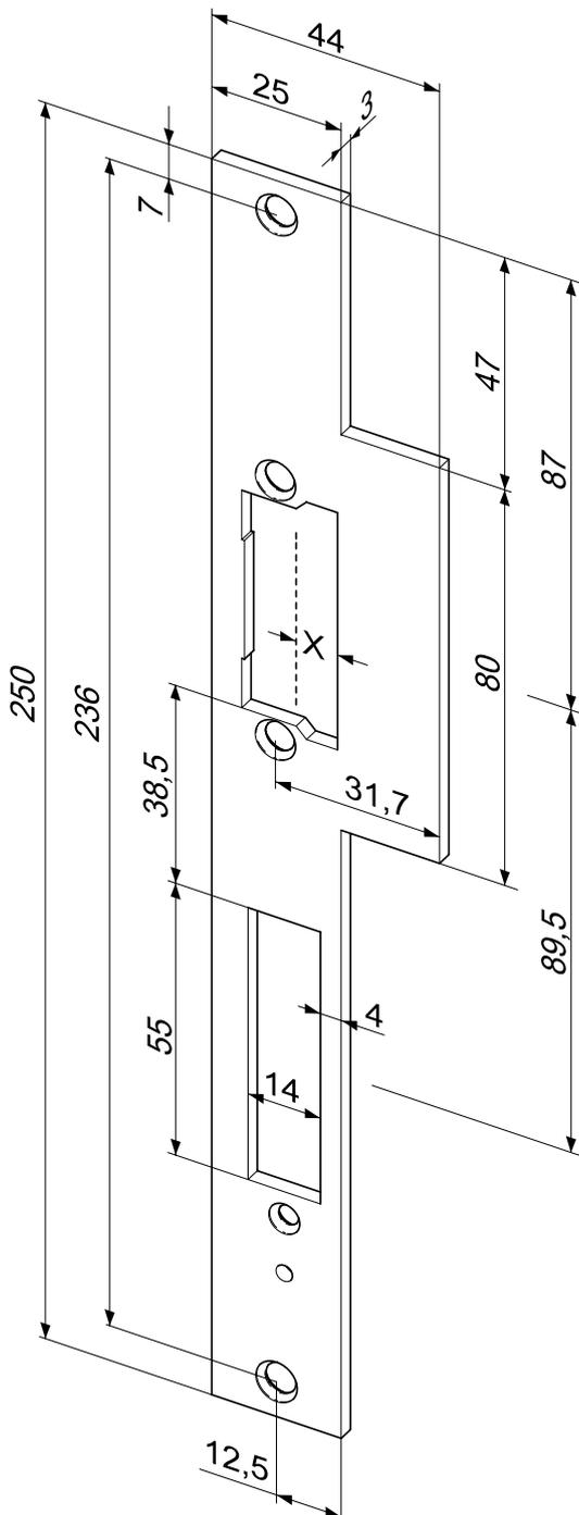
ProFix® 2 Flachschließblech mit Fallen- und Riegelausschnitt.
