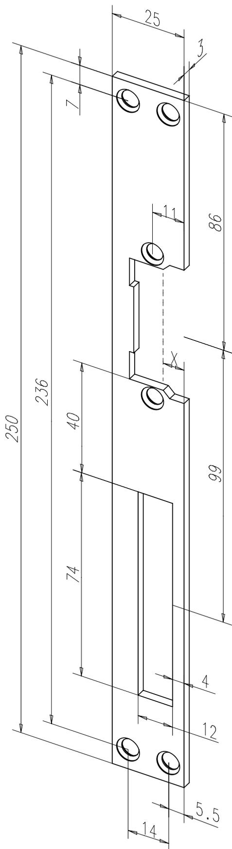
Flachschließblech mit Fallen- und Riegelausschnitt.
