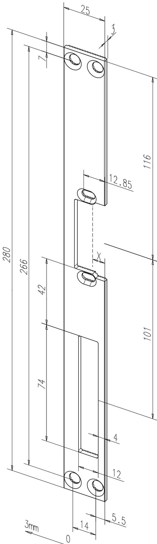
Flachschließblech mit Fallen- und Riegelausschnitt.
