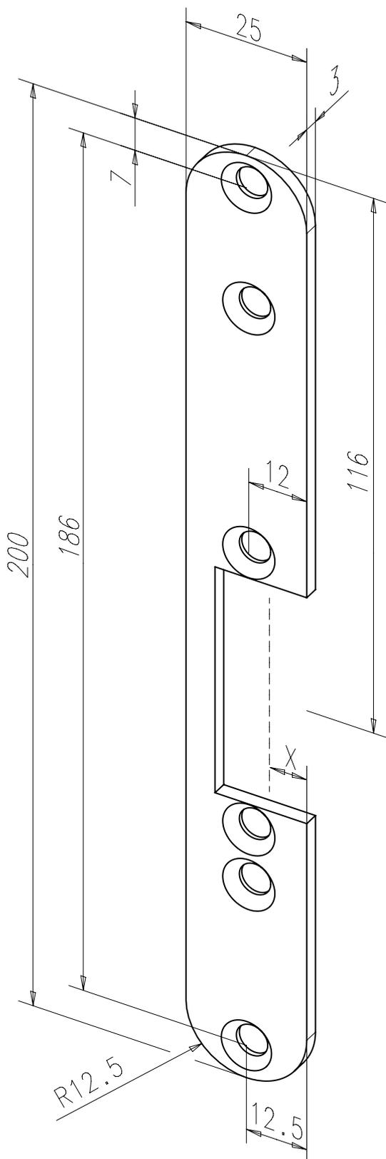
Kurzes Flachschließblech mit Fallenausschnitt.
