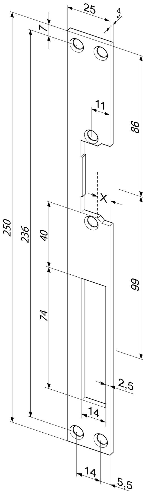
Flachschließblech mit Fallen- und Riegelausschnitt.
