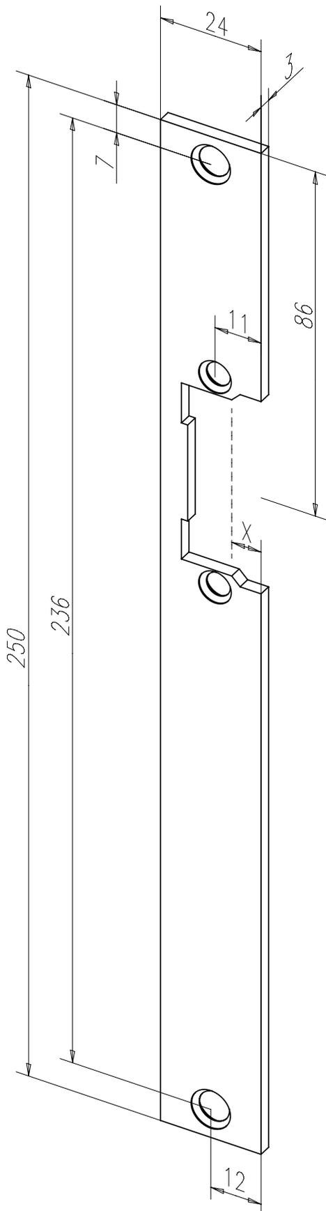
Standard-Flachschließblech mit Fallenausschnitt.
