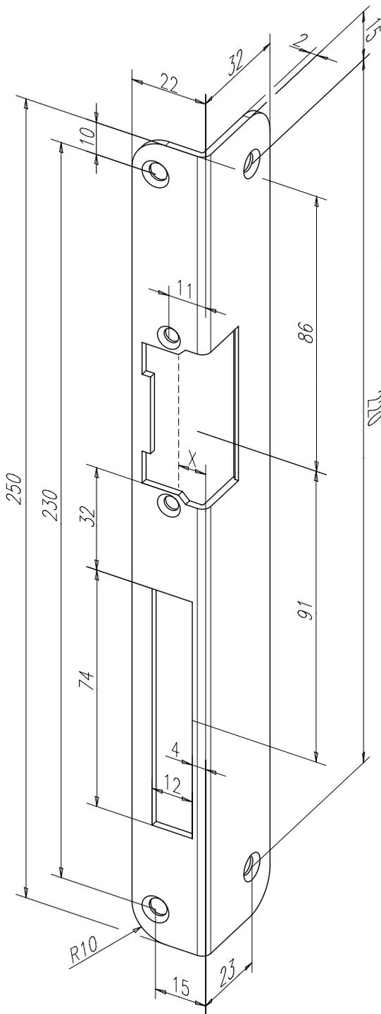
Standard-Winkelschließblech mit Fallen- und Riegelausschnitt.
