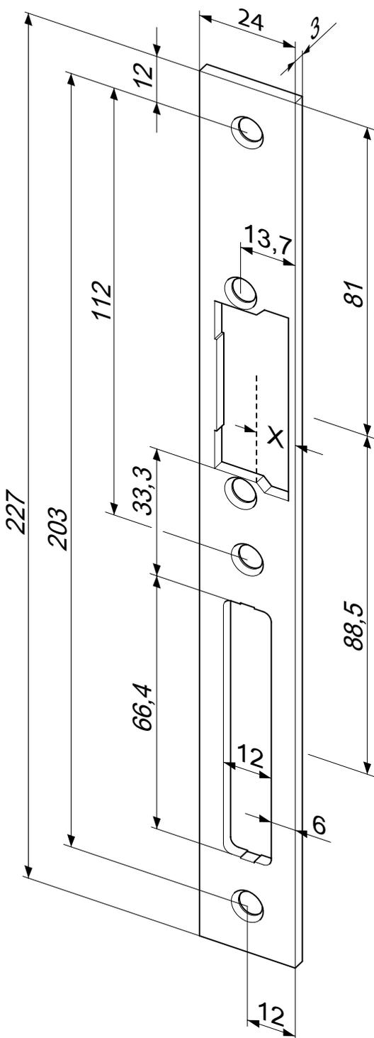
Flachschließblech mit Fallen- und Riegelausschnitt.
