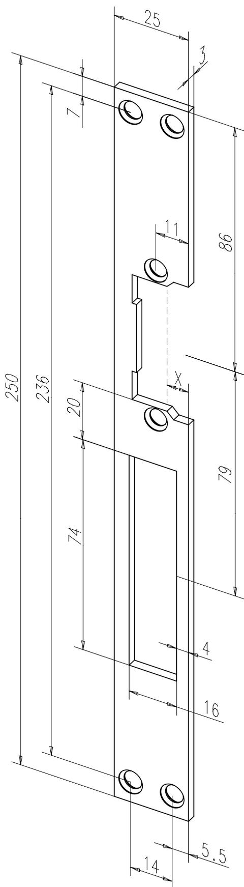
Standard-Flachschließblech mit Fallen- und Riegelausschnitt.
