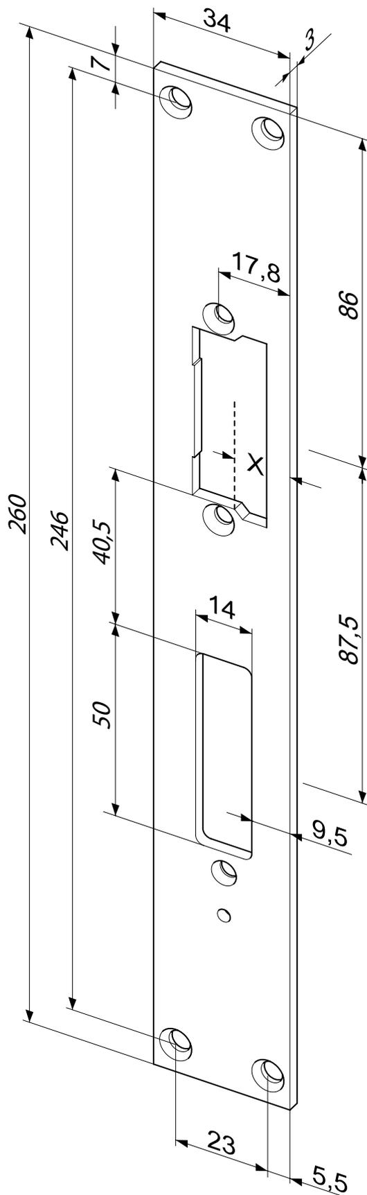
Flachschließblech mit Fallen- und Riegelausschnitt.
