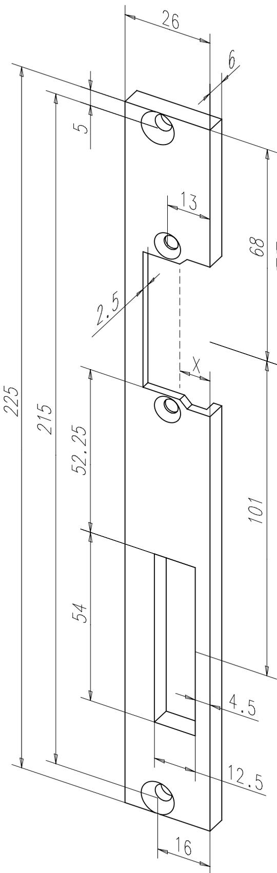
Flachschießblech mit Fallen- und Riegelausschnitt.
