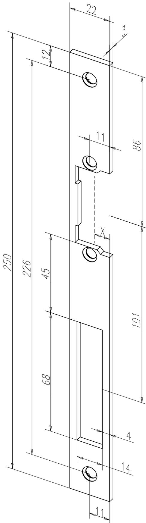
Flachschließblech mit Fallen- und Riegelausschnitt.
